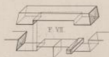
Stoß mit eingesetztem Haken u. Keil.
