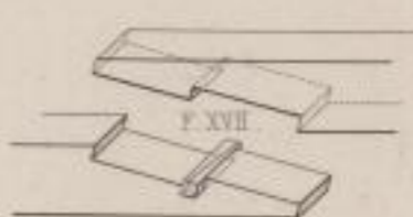
Schräges Hakenblatt mit Keil.
