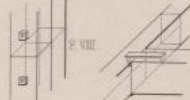
gerader Stoß mit Verholzung.
