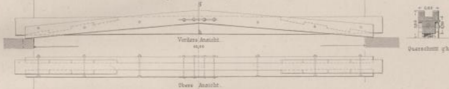
Fig 5 Armierter u. versahnter Träger
