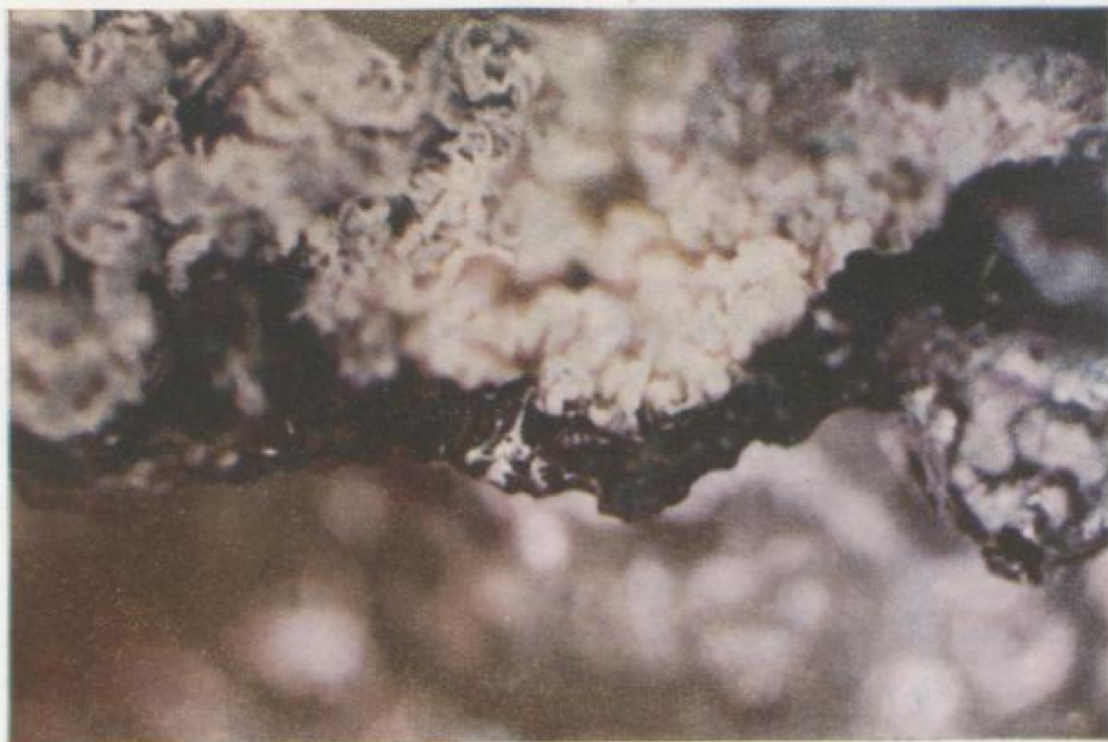
Bild 25. Bruchbild eines Zinnabstriches von einer Schmelze mit 0,66 Gew.-% Sn. Bild läßt den SnO-Film erkennen, der sich an der Unterseite des Abstriches, die mit der Schmelze in Berührung steht, ausgebildet hat. V = 50 Dunkelfeld
