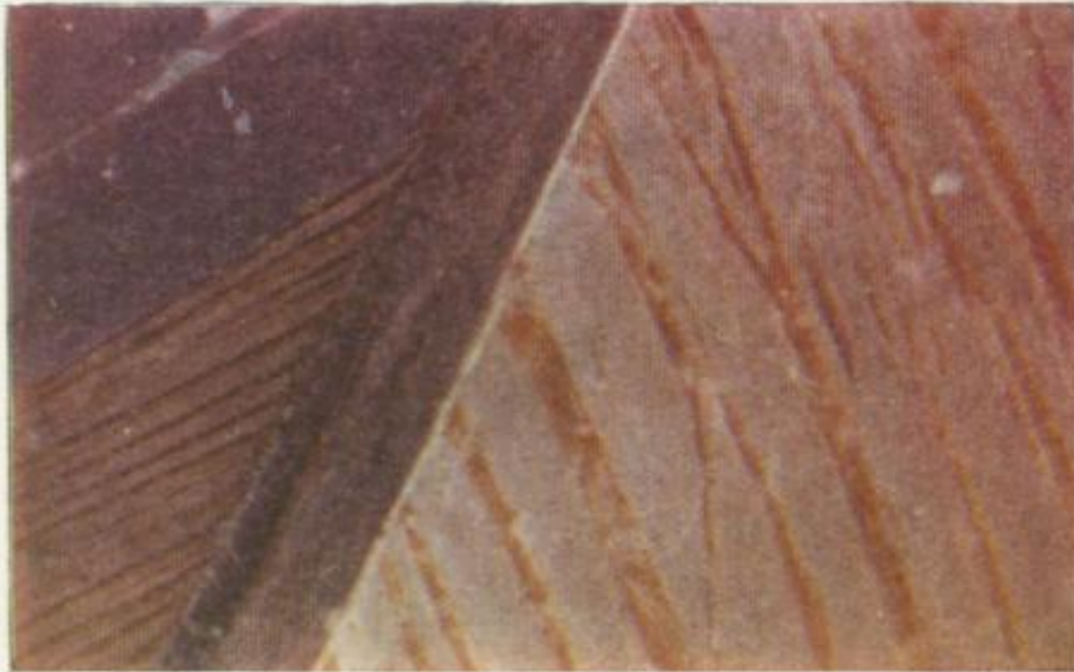
Bild 5b. \text{PbO} + 0,31 \text{ Gew.-% SnO}_2 V = 200 Dunkelfeld. Die Dunkel- feldbeleuchtung läßt die zwei Pha- sen besser erkennen
