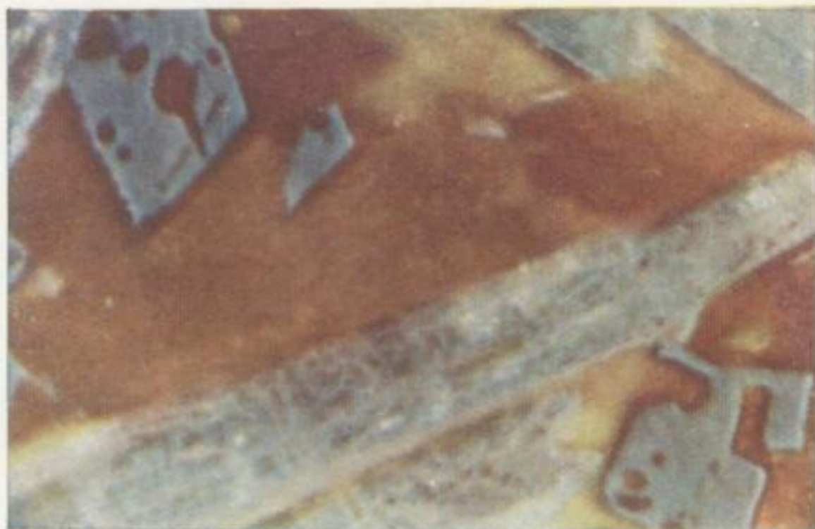
Bild 5h. \text{PbO} + 12,10 \text{ Gew.-% SnO}_2 V = 200 . Blaufärbung der 2 \text{ PbO} \cdot \text{SnO}_2 -Kristalle im pol. Licht
