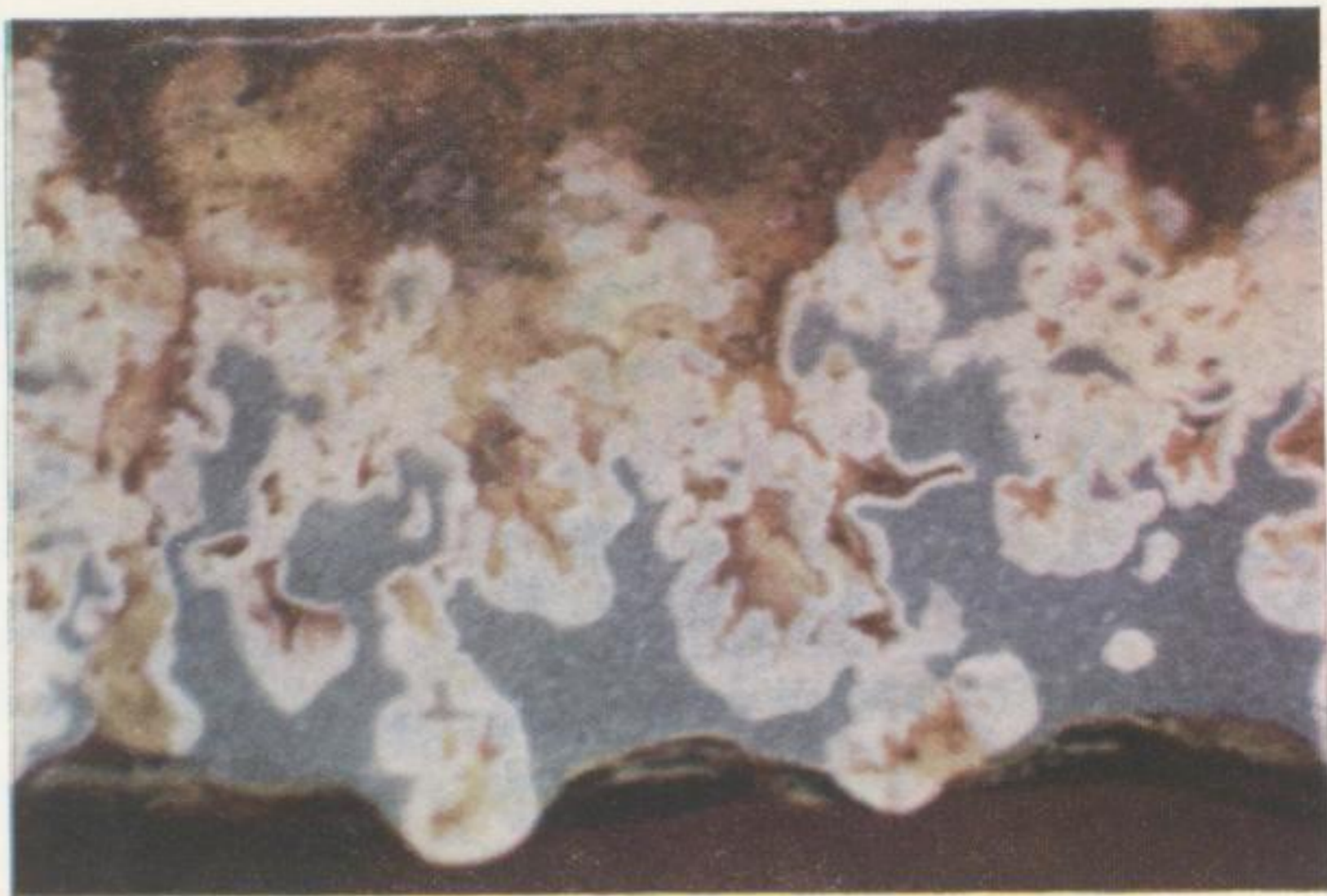
Bild 24. Querschliff durch einen Zinnabstrich von einer Schmelze mit 0,28 Gew.-% Sn. Bild zeigt das Hineinwachsen der Oxydschicht in die Schmelze und die entstehende Oberflächenvergrößerung. V = 50 Dunkelfeld
