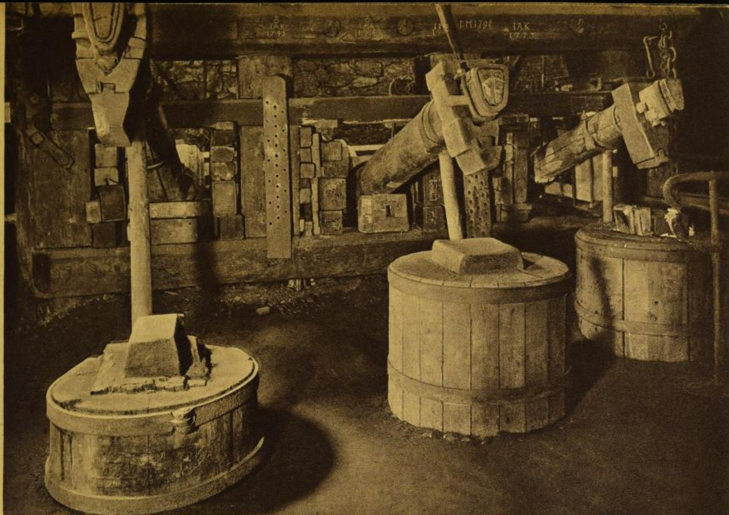
Eisenhämmer der Frohnauer Hammermühle. Prägstätte der „Schreckenberger“, einer wegen ihres hohen Silbergehalts im 16. Jahrhundert sehr geschätzten Münzsorte, die ihren Namen nach der Fundgrube am Schreckenberg hatte
