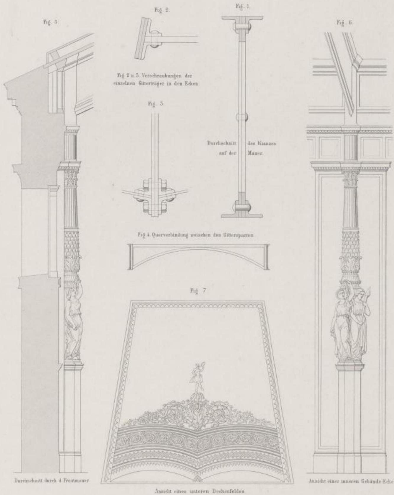
Fig. 2 u. 3. Verschraubungen der einzelnen Gitterträger in den Ecken.
