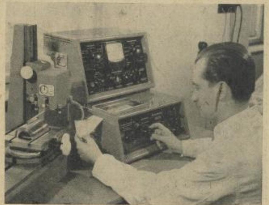
Das Oberflächenprüfgerät Perth-O-Meter in Verbindung mit dem Schreibgerät Perth-O-Graph ist zur Prüfung der Kenngrößen der Oberflächenrauheit geeignet. Da die Funktionstauglichkeit vieler Teile von der Oberflächenrauheit abhängig ist, bringt der Einsatz dieses Gerätes wertvolle Ergebnisse bei Forschungsarbeiten und bei der Kontrolle der erreichten Oberflächenqualität in der Fertigung.
