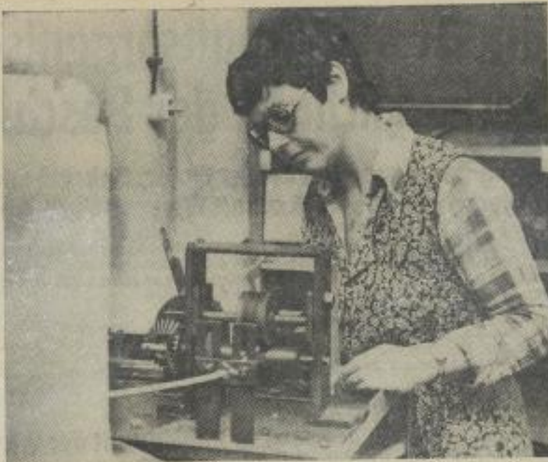
In gemeinsamer Arbeit von Wissenschaftlern und Studenten der Sektion FPM und der PGH des Blindenhandwerks wurde diese neuartige Weidenrutenschälmaschine entwickelt. Mit dieser Maschine können in einer Schicht bis zu 15 Dezitonnen Weidenruten geschält werden.
