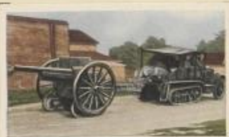
Französisches Feldgeschütz auf dem Transport. Kleine abgefederte Rollgestelle dienen als schließendes Transportmittel
