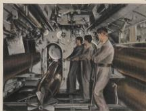
Torpedoraum des englischen U-Bootes „L 56“. Die Mannschaft bringt den Torpedo gerade in das Ausstoßrohr
