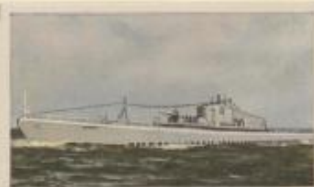
Amerikanisches U-Boot „V 6 Nautilus“. Besatzung 88 Mann. Wasserverdrängung 3040 t. Bestückung 2 × 15,2 cm Kanonen und 4 Torpedoausstoßrohre
