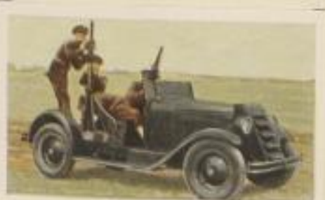
Englischer Traktor für den Mannschafts- und Munitionstransport, auch als Zugmaschine für Geschütze verwendbar
