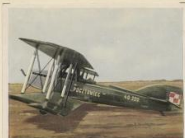
Polnischer Aufklärer „Potez 15 A 2“. Motorleistung 400 P.S. Höchstgeschwindigkeit 210 km pro Std. Gipfelhöhe 6200 m. Flugweite 550 km
