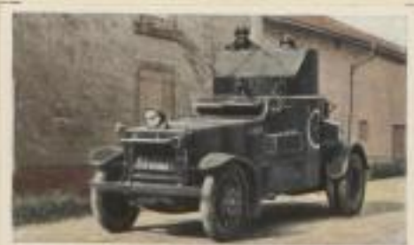
Französischer White-Straßenpanzer. Besatzung 4 Mann. Bewaffnung 1 x 37 mm halbautomatische Kanone und 1 Drehturm-MG. in Turm. Munition 198 Granatpatronen und 5568 Schuß MG.
