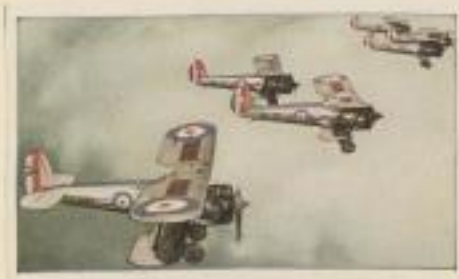
Französischer Jagdeinsitzer „Bernard 20C1“. Motorleistung 500 PS. Höchstgeschwindigkeit 280 km pro Std. Gipfelhöhe 8000 m. Bewaffnung 2 starke MG.
