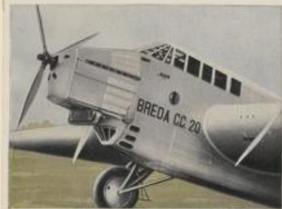
Italienischer Nachtbomber „Breda CC 20“ für Fernangriffe. Motorleistung 3 x 50 P.S. Höchstgeschwindigkeit 230 km pro Std. Flugweite 3000 km. Bombenlast 1500 kg. Bewaffnung 6 MG. u. 1 x 20 mm MR.
