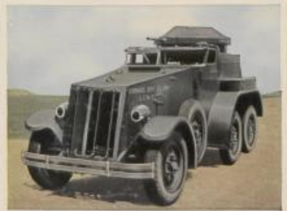
Amerikanischer Straßenpanzer mit Viersadentrieb und einem drehbaren Panzerturm. Bewaffnung 1 MG. und 1 KK. Munition 7200 Schuß. Geschwindigkeit 72 km pro Std.
