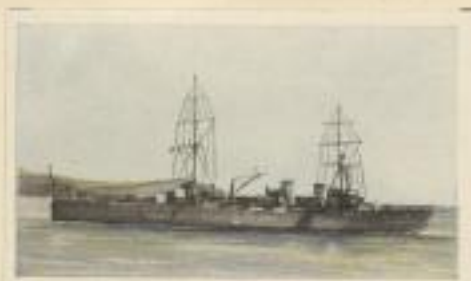
französischer geschützter Kreuzer „Dugan Trouin“, Besatzung 578 Mann, Wasserverdrängung 9350 t, Bestückung 8 × 15,5 cm Kanonen und 12 Torpedoausstoßrohre
