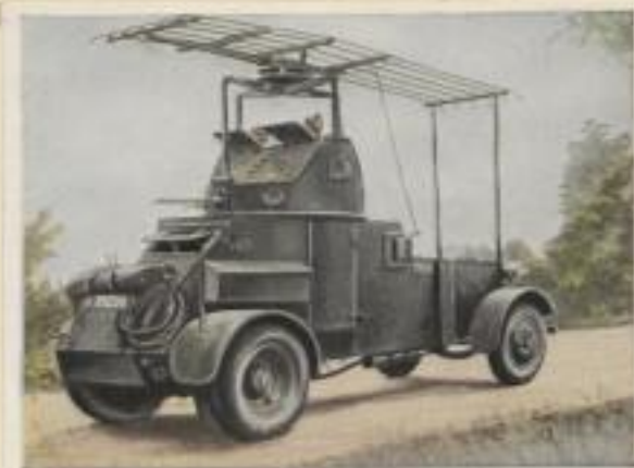
Französischer Straßenpanzerwagen mit Radioanlage für den Befehls-empfang und Nachrichtenübermittlung
