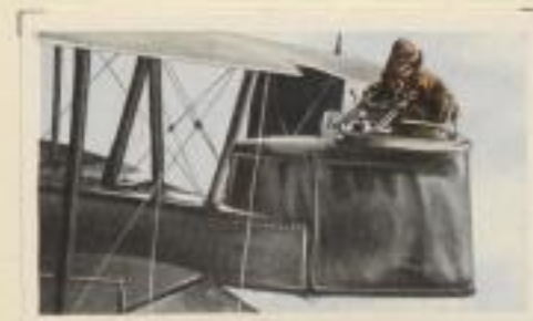
Heckstand des englischen Nachtbombers „Vickers Virginia“. Der MG-Schütz im Heckstand hinter dem Leitwerk verteidigt die Angriffe aus dem Rückhalt
