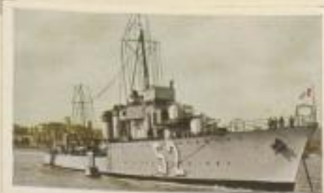
Französischer Zerstörer „Mistral“. Besatzung 153 Mann, Wasserverdrängung 1800 t, Bewaffnung 4 × 13 und 1 × 7,5 cm Kanonen, Geschwindigkeit 33,5 km
