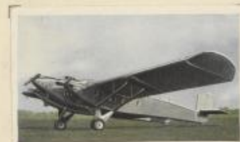
Französischer Truppentransporter „Dole et Baraban“ DB 70“. Motorleistung 3 × 600 PS. Höchstgeschwindigkeit 190 km pro Stunde. Fassungsvermögen 28 Infanteristen
