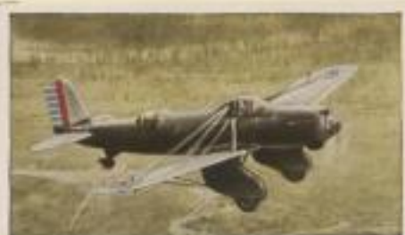
Amerikanischer Jagdweisser „Curtiss A 8“. Motorleistung 650 P.S. Höchstgeschwindigkeit 350 km pro Std. Gipfelhöhe 9000 m. Bewaffnung 4 starre und 1 bewegliches MG.
