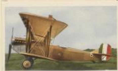
Italienischer Tagbomber „Fiat BR III“. Motorleistung 970 P.S., Höchstgeschwindigkeit 230 km pro Std., Flugweite 850 km, Bombenzuladung 500 kg
