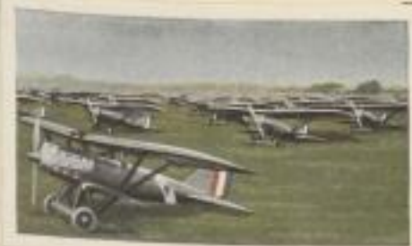
Italienischer Jagdeinsitzer „Fiat CR 20 W“. Motorleistung 440 P.S. Höchstgeschwindigkeit 260 km pro Std. Gipfelhöhe 6000 m. Bewaffnung 2 starre MG.
