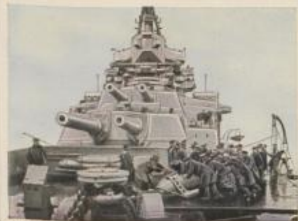
Geschütztürme mit 38,1 cm Kanonen des englischen Schlachtkreuzers „Renown“. Die Mannschaft bereitet einen Torpedo zum Abschuss vor
