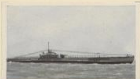
Französisches U-Boot „Prométhée“. Besatzung 63 Mann. Wasserverdrängung 2080 t. Bewaffnung 1 x 10 cm Kanone und 12 Torpedos
