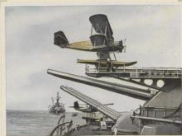
Katapultanlage des amerikanischen Linienschiffes „Kalifornien“. Die modernen amerikanischen Linienschiffe führen 2 Katapulte und 5 Hochflugzeuge mit sich
