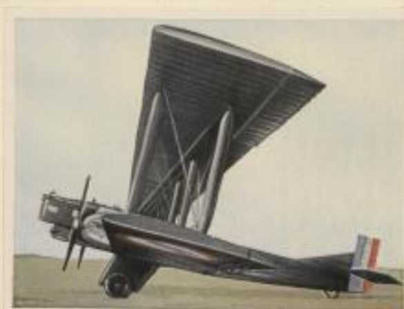
Französischer Nachtbomber „Farman F 160“. Motorleistung 2 x 500 P.S. Höchstgeschwindigkeit 190 km pro Std. Flugweite 1000 km. Bombenlast 2200 kg
