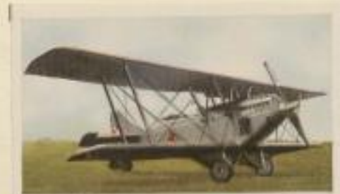
Polnischer Aufklärer „Lublin R 8“. Motorleistung 700 P.S. Höchstgeschwindigkeit 230 km pro Std. Gipfelhöhe 6500 m. Flugweite 1500 km
