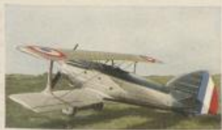
Neuester französischer Jagdeinsitzer „Hanriot 110C1“. Motorleistung 650 P.S. Höchstgeschwindigkeit 360 km pro Std. Gipfelhöhe 11000 m. Bewaffnung 2 starre MG. und eine Maschinenkanone
