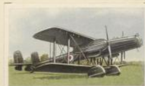
Englischer Nachtbomber „Handley Page Denford“. Motorleistung 2 x 550 P.S. Höchstgeschwindigkeit 230 km pro Std. Flugweite 1100 km. Bombenladung 1000 kg
