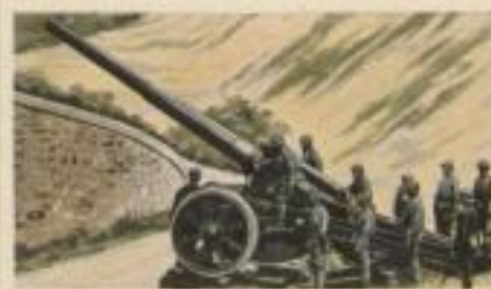
Französisches schweres Geschütz „K. M. 17“. Kaliber 22 cm. Geschützgewicht 103 kg. Geschützgewicht etwa 27 000 kg. Schußweite 22,8 km
