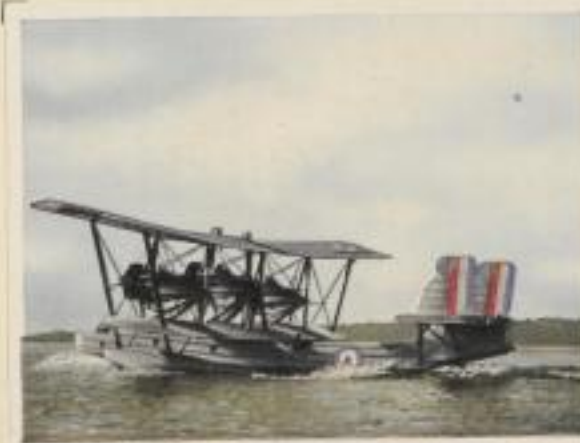
Englisches Patrouillenboot „Supermarine Southampton 10“. Motorleistung 3 x 550 PS. Höchstgeschwindigkeit 220 km pro Std. Flugweite 1500 km. Bombenladung 1600 kg
