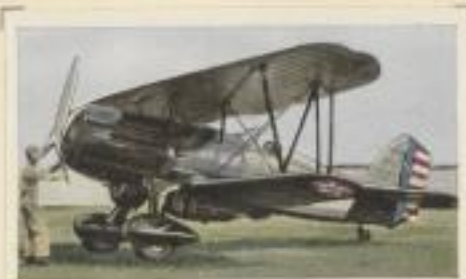
Amerikanischer Jagdeinflieger „Curtis P 6 E“. Motorleistung 640 P.S. Höchstgeschwindigkeit 310 km pro Std. Gipfelhöhe 6000 m. Bewaffnung 2 fest eingebaute MG.
