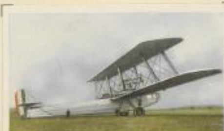
Größter italienischer Nachtbomber „Caproni 90 PB“. Das größte Bombenflugzeug der Welt. Motorleistung 6 x 1000 P.S. Höchstgeschwindigkeit 205 km pro Std. Flugweite 2000 km. Bombenlast 8000 kg
