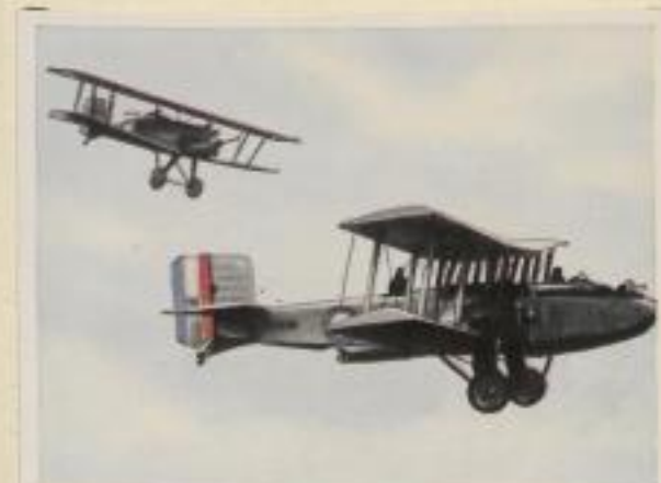
Englischer Tagbomber „Boulton and Paul P 20“ in Begleitung eines Jagdreinigers. Motorleistung 2 x 460 P.S., Höchstgeschwindigkeit 236 km pro Std., Flugweite 1200 km, Bombenzuladung 1000 kg
