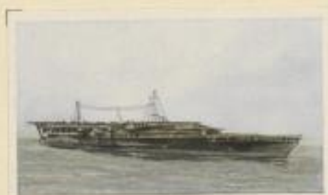
Japanisches Flugzeugmutter Schiff „Akagi“. Besatzung 800 Mann. Wasserverdrängung 22000 t. Fassungsvermögen 80 Flugzeuge
