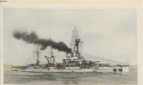
französischer Panzerkreuzer „Jean Bart“, Besatzung 1113 Mann, Wasserverdrängung 23550 t, Bestückung 12 × 30,5 und 22 × 13,8 cm Kanonen, Maschinenleistung 28 000 P.S.
