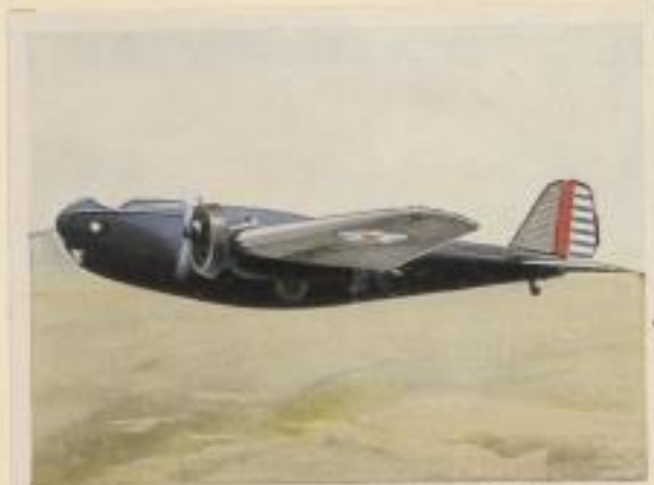
Amerikanischer Tagbomber „Stearman X B-907“. Motorleistung 2 x 575 P.S., Höchstgeschwindigkeit 340 km pro Std., Flugweite 1000 km, Bombenzuladung 1000 kg
