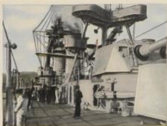
An Deck des französischen geschützten Kreuzers „Colbert“. Der Kreuzer besitzt außer Bestückung von 8 × 20,3 und 8 × 10 cm Kanonen eine Katapultanlage mit 2 Flugzeugen
