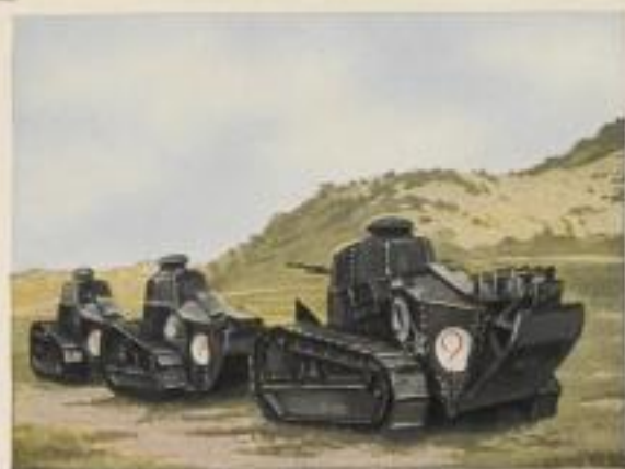
Französische Renault-Tanks auf dem Vormarsch. Besatzung 3 Mann. Bewaffnung 1 kurze 55 mm Kanone und 4 MG.
