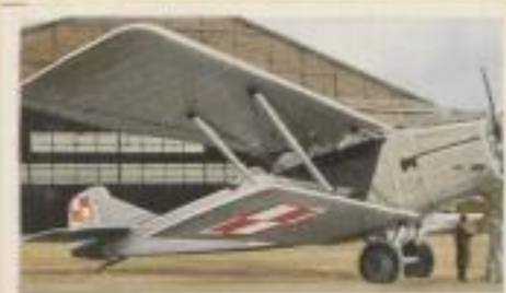
Polnischer Tagbomber „S.E.C.M. 120“. Motorleistung 600 PS. Höchstgeschwindigkeit 200 km pro Std. Flugweite 1000 km. Bombenzuladung 600 kg.
