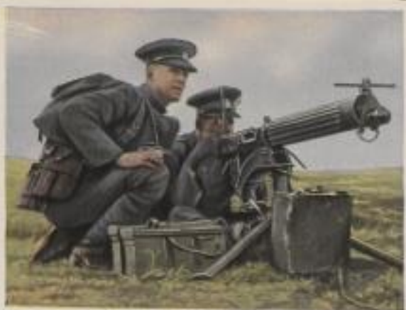
Englisches schweres MG. Das MG. schießt 900 bis 1000 Schuß pro Minute und wird von mehreren Mann bedient
