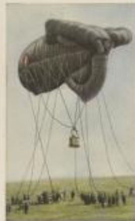
Französischer Fesselballon. Der Beobachter, mit Telefon, Photoapparaten und Fallschirm ausgerüstet, beobachtet die Front, um besondere Ereignisse sofort zu melden
