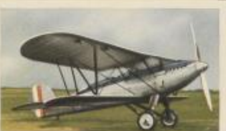
Englischer Jagdweisser „Fairey Fox 2“. Motorleistung 650 P.S. Höchstgeschwindigkeit 340 km pro Std. Gipfelhöhe 8000 m. Bewaffnung 2 starre und 1 bewegliches MG.
