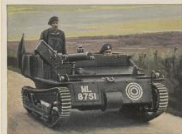
Engl. 3-Mann-Tank „Carden-Lloyd-Mod. VI“. Bewaffnung 1 Vickers-MG, oder 1 x 47 mm Kanone. Munition 3500 Schuß, Panzerung 8 mm
