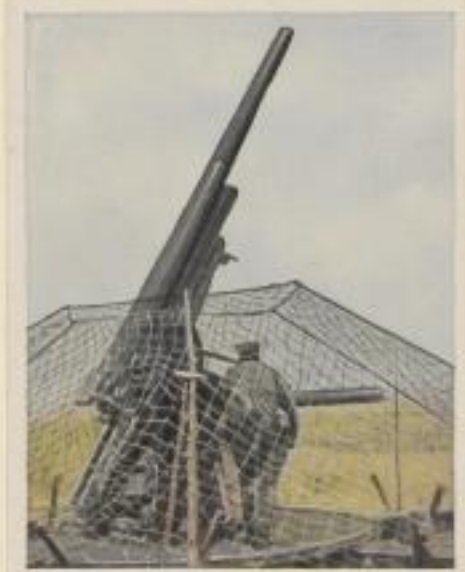
Japanisches stationäres Flugabwehrgeschütz. Kaliber 7,5 cm. Wirksame Schußhöhe 7000 m
