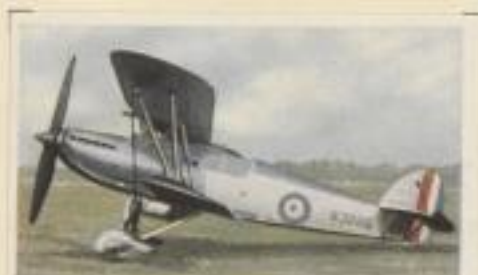
Englischer Jagdeinsitzer „Hawker Fury“. Motorleistung 630 P.S. Höchstgeschwindigkeit 410 km pro Std. Gipfelhöhe 10 000 m. Bewaffnung 2 starre MG.
