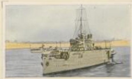
Italienisches Flugzeugmuttereschiff „Giuseppe Miraglia“. Besatzung 130 Mann. Wasserverdrängung 4891 t. Fassungsvermögen 20 Flugzeuge
