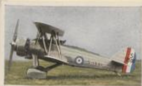
Englischer Jagdeinsitzer „Armstrong AW 16“. Motorleistung 340 P.S. Höchstgeschwindigkeit 320 km pro Std. Gipfelhöhe 9000 m. Bewaffnung 2 starre MG.
