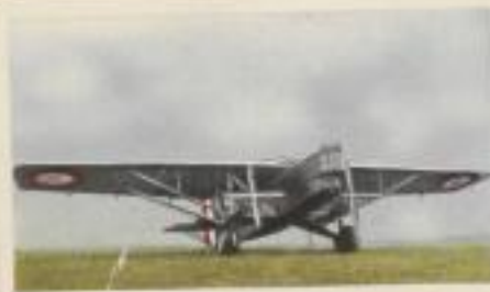
Französischer Nachtbomber „Farman F 211“. Motorleistung 4 x 230 P.S. Höchstgeschwindigkeit 195 km pro Std. Flugweite 1500 km. Bombenladung 1900 kg
