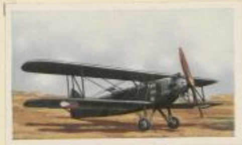
Schwedischer Aufklärer „Letov S 210“. Motorleistung 480 P.S. Höchstgeschwindigkeit 230 km pro Std. Gipfelhöhe 7000 m. Flugweite 600 km
