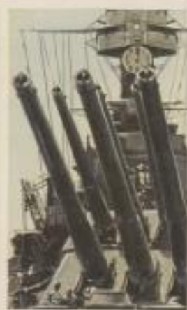
35,6 cm Langrohrgeschütze des amerikanischen Linienschiffes „Kalifornien“. Schwere 35 km
