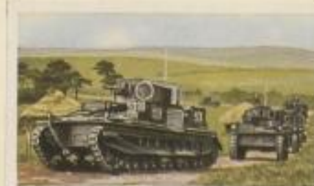
Englischer schwerer Medium-Vickers-Tank „Mk 2“ auf dem Vormarsch. Die Höchstgeschwindigkeit beträgt 30 km pro Stunde bei einer Motorleistung von 90 PS
