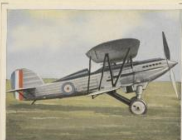
Englischer Jagdeinsitzer „Fairey II M“. Motorleistung 620 P.S. Höchstgeschwindigkeit 350 km pro Std. Gipfelhöhe 9600 m. Bewaffnung 2 starre MG.
