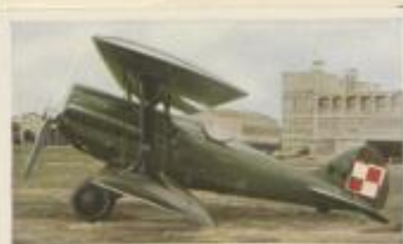
Polnischer Jagdeinsitzer „Blériot S 61 C1“. Motorleistung 450 P.S. Höchstgeschwindigkeit 260 km pro Std. Gipfelhöhe 7500 m. Bewaffnung 2 MG.
