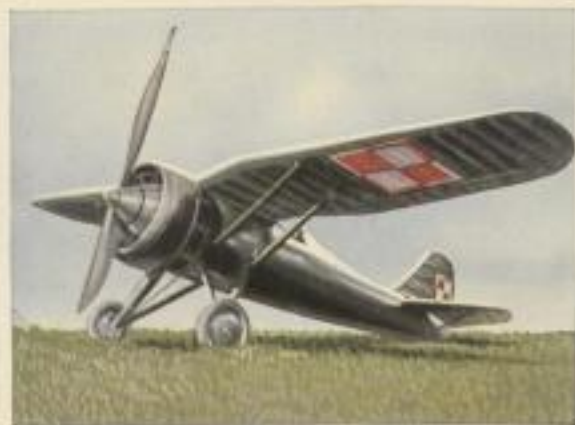
Polnischer Jagdeinsitzer „PZL 11“. Motorleistung 520 P.S. Höchstgeschwindigkeit 350 km pro Std. Gipfelhöhe 9000 m. Bewaffnung 2 starre MG.
