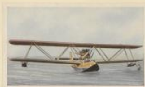
Italienisches Patrouillenboot „Marchi M 24 bis“. Motorleistung 2 x 500 P.S. Höchstgeschwindigkeit 190 km pro Stunde. Flugweite 1500 km. Bombenlast 400 kg
