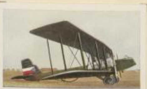
Tschechischer Nachtbomber „Aero A 24“. Motorleistung 2×245 P.S., Höchstgeschwindigkeit 160 km pro Std. Flugweite 600 km. Bombenlast 400 kg
