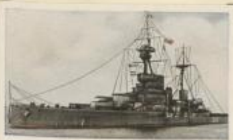
Englisches Linienschiff „Rodney“. Besatzung 1300 Mann. Wasserverdrängung 40000 t. Bestückung 9×40,6 und 12×15,2 cm Kanonen. Selbstwindigkeit 23 km
