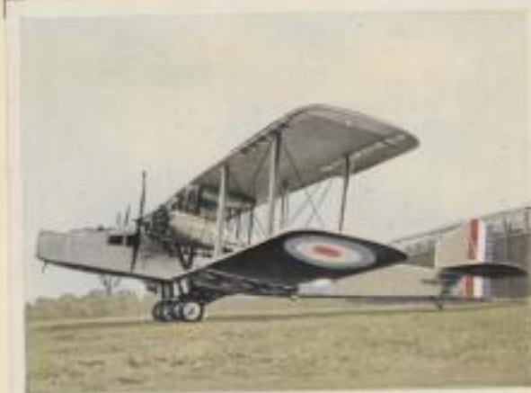
Englischer Nachtbomber „Handley Page Clive“. Motorleistung 2 x 450 P.S. Höchstgeschwindigkeit 178 km pro Std. Flugweite 1230 km bei einer Bombenladung von 1200 kg
