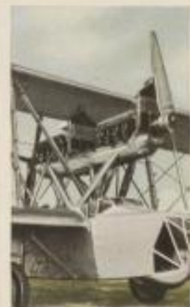
Italienischer Nachtbomber „Caproni 101 Bis“. Motorleistung 2 x 500 P.S. Höchstgeschwindigkeit 245 km pro Std. Flugweite 1100 km. Bombenlast 500 kg
