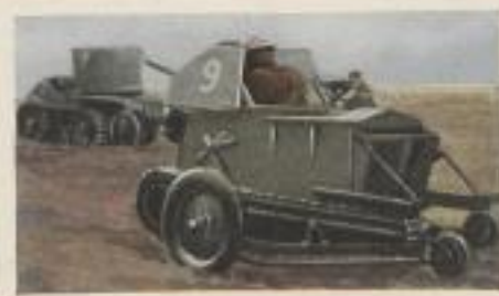
Englisch. 1-Mann-Tank. Das modernste Kriegsinstrument der englischen Armee. Höchstgeschwindigkeit 25 km p. Std.
