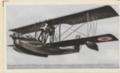
Französischer Aufklärungsflyer „C.A.M.S. 37/2“. Motorleistung 450 PS. Höchstgeschwindigkeit 175 km pro Std. Gipfelhöhe 6000 m. Flugweite 900 km
