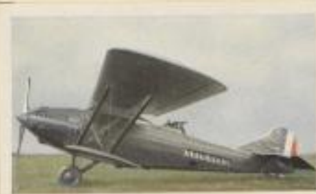
Französischer Tagbombenflugzeug „S. E. C. M. 122 BP“. Motorleistung 650 P.S., Höchstgeschwindigkeit 220 km pro Std., Flugweite 1000 km, Bombenzuladung 400 kg
