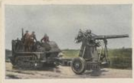
Englisches Abwehrgeschütz auf dem Transport. Kaliber 7,5 cm. Transportgeschwindigkeit 75 km pro Stunde
