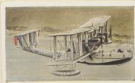
Englisches Patrouillenboot „Blackburn Iris 3“. Motorleistung 3 x 765 PS. Höchstgeschwindigkeit 195 km pro Std. Flugweite 1300 km. Bombenlast 1200 kg
