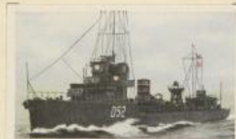
Englischer Zerstörer „Vega“ in voller Fahrt. Besatzung 134 Mann. Wasserverdrängung 1500 t. Bewaffnung 4 x 10,2 cm Kanonen. Höchstgeschwindigkeit 31 km
