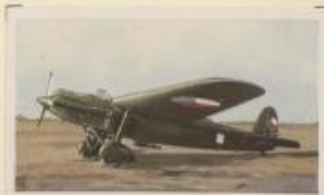
Tschechischer Tagbomber „Aero A 42“. Motorleistung 800 PS. Höchstgeschwindigkeit 270 km pro Std. Flugweite 1000 km. Bombenzuladung 900 kg.
