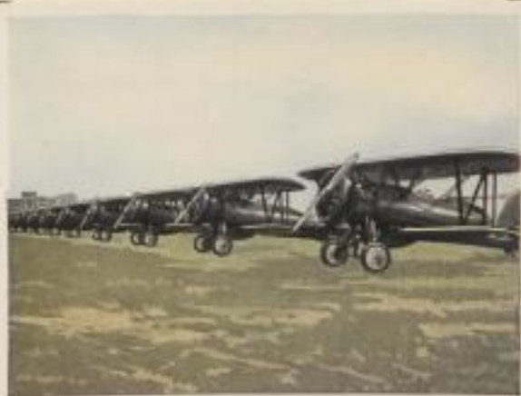
Amerikanischer Jagdeinflieger „Boeing P 12 E“. Motorleistung 550 P.S. Höchstgeschwindigkeit 304 km pro Std. Erreichbare Höhe 7000 m.
