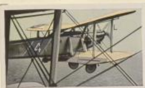
Englischer Torpedoträger „Blackburn Ripon 2“. Motorleistung 530 PS. Höchstgeschwindigkeit 200 km pro Stunde. Bombenlast 1 Torpedo von 750 kg
