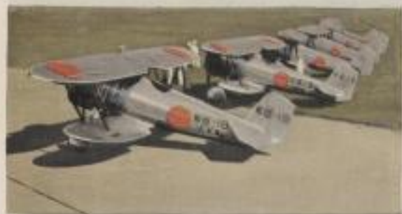
Japanischer Jagdeinsitzer „Nakajima 90“. Motorleistung 450 P.S. Höchstgeschwindigkeit 330 km pro Std. Gipfelhöhe 8000 m. Bewaffnung 2 starre MG.
