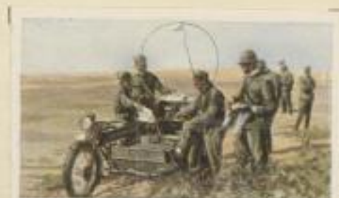
Italienische fahrbare Telegraphenstation. Sie begleitet die Kerntruppe auf dem Vormarsch und übermittelt die Befehle an das und von dem Oberkommando
