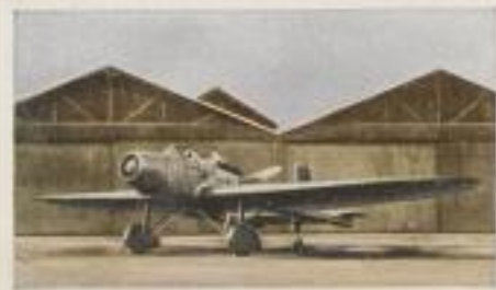
Französischer Jagdeinsitzer „Nieuport 622 C1“. Motorleistung 500 P.S. Höchstgeschwindigkeit 270 km pro Std. Gipfelhöhe 8000 m. Bewaffnung 2 starre MG.
