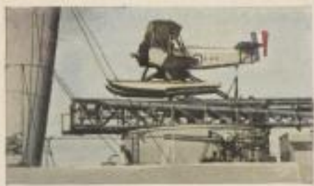
Die Katapultanlage des englischen Linienschiffes „Rodney“ mit einem Fairey-Jagdflugzeug
