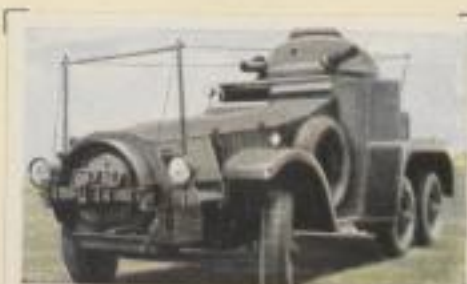
Englisch. Guy-Bonard-Straßenpanzer mit Funkenanlage. Besatzung 5 Mann. Bewaffnung 2 Vickers-MG. Munition 6000 Schuß. Höchstgeschwindigkeit 50 km pro Stunde
