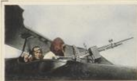
Piloten- und Beobachtersitz eines japanischen Aufklärers. Vor dem Beobachter mit dem beweglichen Maschinengewehr sitzt der Führer des Flugzeuges
