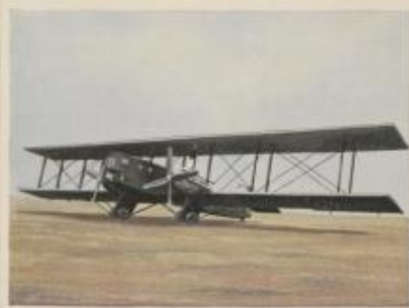
Polnischer Nachtbomber „Pzlan P 160“. Motorleistung 2×500 P.S., Höchstgeschwindigkeit 180 km. Flugweite 1000 km. Bombenladung 2000 kg
