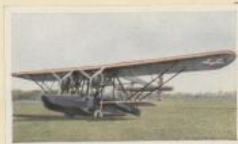
Amerikanisches Patrouillenboot „Naval PN 10“. Motorleistung 2 x 550 PS. Höchstgeschwindigkeit 190 km pro Std. Flugweite 2600 km. Bombenlast 1000 kg
