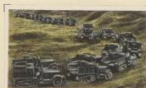
Französische Raupenfahrzeuge für den Truppentransport. Fassungsvermögen 8 Mann. Höchstgeschwindigkeit 40 km pro Stunde
