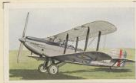
Englischer Aufklärer „Fairley 3 F“. Motorleistung 570 PS. Höchstgeschwindigkeit 260 km pro Std. Gipfelhöhe 7000 m. Flugweite 700 km
