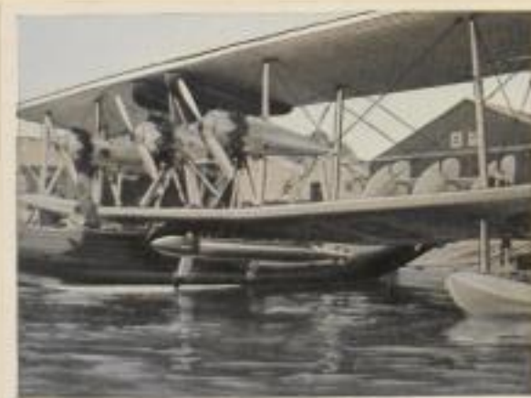
Englisches Patrouillenboot „Supermarine Southampton“. Patrouillenboote werden auch zu Torpedoangriffen eingesetzt, wobei sie mit 2 Torpedos von je 750 kg ausgerüstet werden
