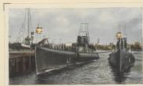
Italienische U-Boote der Klasse Balilla. Besatzung 80 Mann. Wasserverdrängung 1874 t. Bewaffnung 1 x 10 cm Kanone, 6 Torpedoausstößrohre
