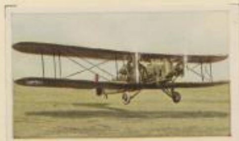
Amerikanischer Nachtbomber „Krykone B 5 A“. Motorleistung 550 PS. Höchstgeschwindigkeit 200 km pro Std. Flugweite 1000 km. Bombenladung 1100 kg
