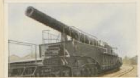
Französisches schweres Eisenbahngeschütz „H. M. 10“. Kaliber 52 cm. Geschützgewicht 275 000 kg. Schußweite 17 km
