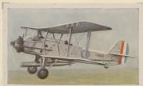
Englischer Torpedoträger „Vickers Valiant“. Motorleistung 525 P.S., Höchstgeschwindigkeit 225 km pro Stunde. Bombenlast 1 Torpedo von 750 kg
