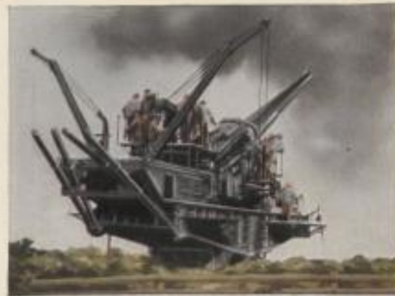
Amerikanisches neues Küstengeschütz auf drehbarer Lafette im Feuer. Kaliber 35,5 cm. Schußweite etwa 44 km
