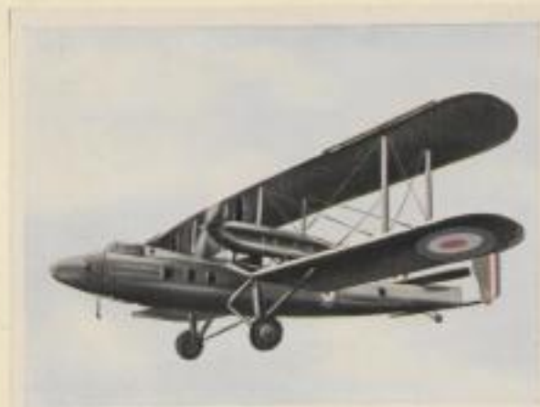
Englischer Truppentransporter „Gloster“. Motorleistung 4 × 540 PS. Höchstgeschwindigkeit 240 km pro Stunde. Besatzung 4 Mann. Fassungsvermögen 32 Infanteristen
