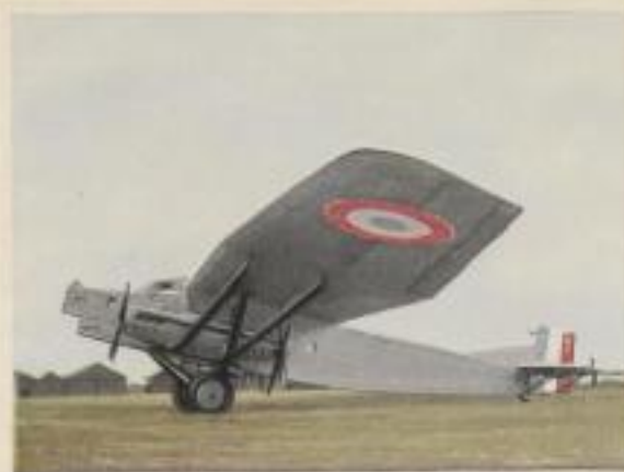
Modernster französischer Nachtbomber „Farman F 220“. Motorleistung 4 x 600 P.S. Höchstgeschwindigkeit 250 km pro Std. Flugweite 1200 km. Bombenlast maximal 4000 kg
