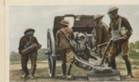
Englische schwere Haubitze in Feuerstellung. Kaliber 11,43 cm. Gewicht etwa 1360 kg. Schußweite 6,4 km
