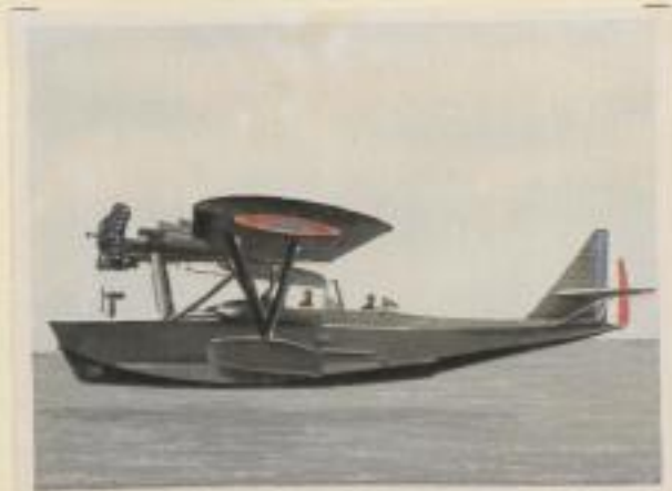
Französisches Katapultflugboot „Potez 43“. Motorleistung 250 P.S. Höchstgeschwindigkeit 180 km pro Std. Gipfelhöhe 4400 m
