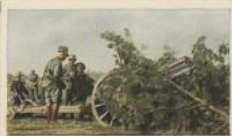
Italienisches Feldgeschütz in Feuerstellung. Feldgeschütze von 7,5 cm Kaliber wiegen etwa 650 kg und schießen 6,5 km weit
