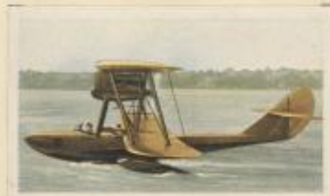
Italienisches Jagdflugboot „Savoia S 58“. Motorleistung 400 P.S. Höchstgeschwindigkeit 280 km. Gipfelhöhe 6000 m. Bewaffnung 2 festeingebaute MG.
