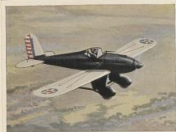
Amerikanischer Jagdeinflieger „Curtis XP 934“. Motorleistung 640 P.S. Höchstgeschwindigkeit 340 km pro Std. Gipfelhöhe 8000 m. Bewaffnung 2 starre MG.
