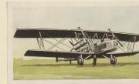
Bestster englischer Nachtbomber „Vickers 163“. Motorleistung 4 x 360 P.S. Höchstgeschwindigkeit 220 km pro Std. Flugweite 2000 km. Bombenladung 2000 kg
