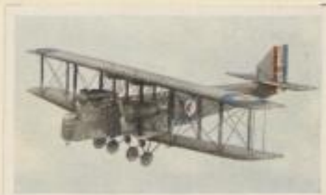
Englischer Nachtbomber „Handley Page Hinaidi II“. Motorleistung 2 x 450 P.S. Höchstgeschwindigkeit 185 km pro Std. Flugweite 1600 km. Bombenladung 700 kg
