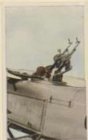
Englischer Aufklärer „Vickers Vespa“. Zur Verteidigung gegen Angriffe bedient sich der Beobachter eines nach allen Richtungen hin schwenkbaren Zwillingsmaschinengewehrs
