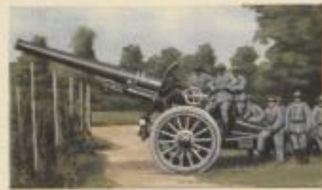
Französisches Langrohrgeschütz. Kaliber 15,5 cm, Gewicht etwa 11 200 kg. Schußweite 20 km
