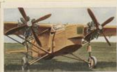
Italienischer Tagbomber „Caproni 102 B1B“. Motorleistung 2 x 500 P.S., Höchstgeschwindigkeit 245 km pro Std., Flugweite 1140 km, Bombenzuladung 450 kg
