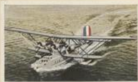
Französisches Patrouillenschiffboot „Breguet Biere“. Motorleistung 3 x 850 P.S. Höchstgeschwindigkeit 250 km pro Std. Flugweite 1800 km. Bombenlast 1000 kg
