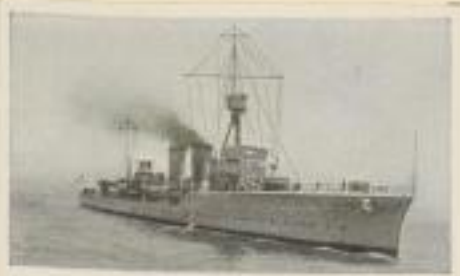
Englischer kleiner Kreuzer „H. M. S. Champion“. Besatzung 368 Mann, Wasserverdrängung 4850 t, Bewaffnung 4 × 15,2 cm und 17,6 cm Kanonen, Geschwindigkeit 29 km
