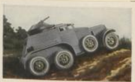
Amerikanischer Panzerwagen „T-4“. Nimmt zwanzigprozentige Steigung, Bewaffnung 1 MG. und 1 MK. Panzerung 3 mm. Höchstgeschwindigkeit 75 km
