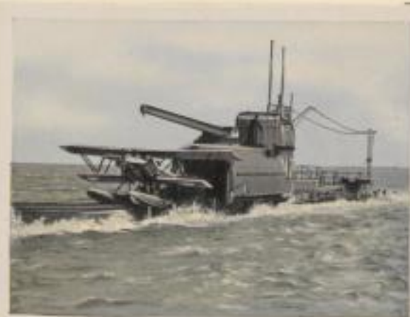
Englisches U-Boot „M 2“ mit Bordflugzeug und Katapultanlage. Besatzung 60 Mann. Wasserverdrängung 1950 t. Bewaffnung 1 x 7,6 cm Kanone und 4 Torpedoausstößrohre
