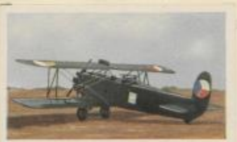
Schwedischer Aufklärer „Avia BH 26“. Motorleistung 480 P.S. Höchstgeschwindigkeit 240 km pro Std. Gipfelhöhe 8000 m. Flugweite 600 km
