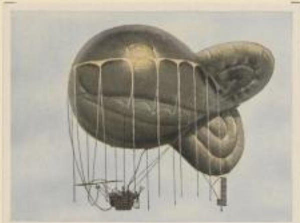
Italienischer Fesselballon. Mit kleinem Motor ausgerüstet, soll der Ballon imstande sein, im Gefahrefalle die Landemannöver zu erleichtern
