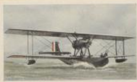
Französisches Patrouillenschiffboot „Cano 51 R III“. Motorleistung 2 x 450 P.S. Höchstgeschwindigkeit 200 km. Flugweite 1000 km. Besatzung 5 Mann
