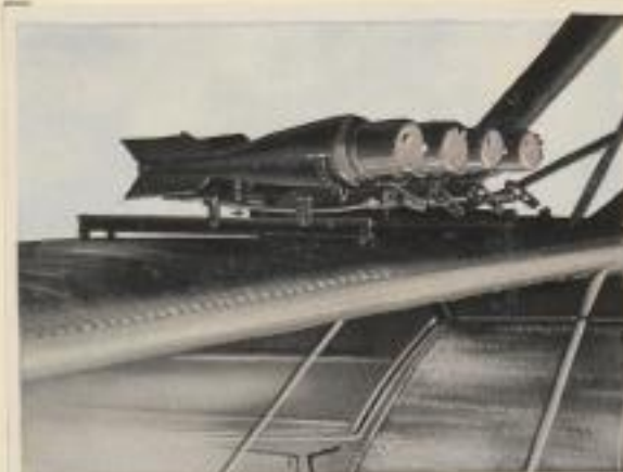
Bombenanlage des englischen Jagdeinsitzers „Bristol Bulldog“. Die Bomben sind in Vorrichtungen aufgehängt, die vom Piloten bedient werden, um die Bomben im Einfangriff auf lebende Ziele zu werfen
