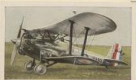
Englischer Jagdeinsitzer „Bristol Bulldog“. Motorleistung 520 PS. Höchstgeschwindigkeit 320 km pro Std. Gipfelhöhe 9000 m. 2 starke MG. und 10 Splinterbomben
