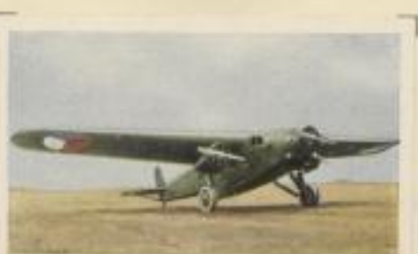
Tschechischer Nachtbomber „Avia BH 39“. Motorleistung 3×500 P.S., Höchstgeschwindigkeit 240 km pro Std. Flugweite 1500 km. Bombenlast 1200 kg
