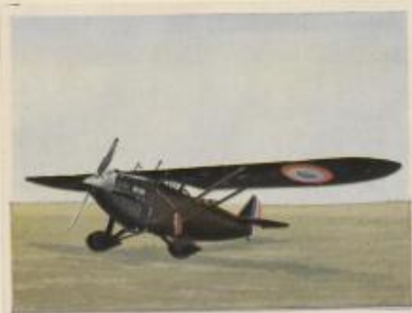
Franz. Aufklärer „Latécoère 491“. Motorleistung 650 P.S. Höchstgeschwindigkeit 276 km pro Std. Gipfelhöhe 8000 m. Flugweite 750 km
