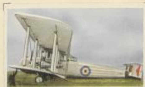
Englischer Truppentransporter „Vickers Victoria“. Motorleistung 2 × 520 PS. Höchstgeschwindigkeit 220 km pro Stunde. Fassungsvermögen 24 Infanteristen
