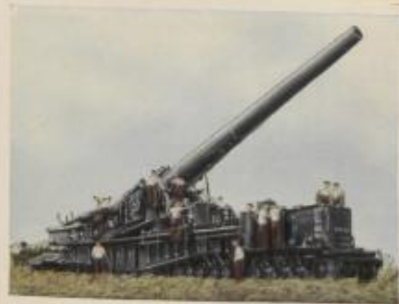
Amerikanisches schweres Eisenbahngeschütz. Kaliber 40 cm. Geschützgewicht etwa 137 000 kg. Schußweite 16 km
