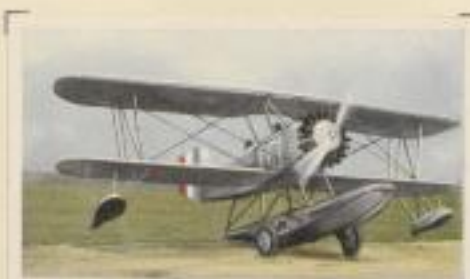
Amerikanischer Katapultflugzeug „Curtiss O 2 U“. Motorleistung 425 PS. Höchstgeschwindigkeit 230 km pro Std. Gipfelhöhe 5600 m. Dient als Beobachtungsflugzeug für Kriegsschiffe
