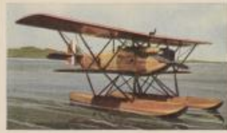
Italienischer Jagdeinsitzer „Fiat CR 30“. Motorleistung 800 P.S. Höchstgeschwindigkeit 360 km pro Std. Gipfelhöhe 9000 m. Bewaffnung 2 starre MG.
