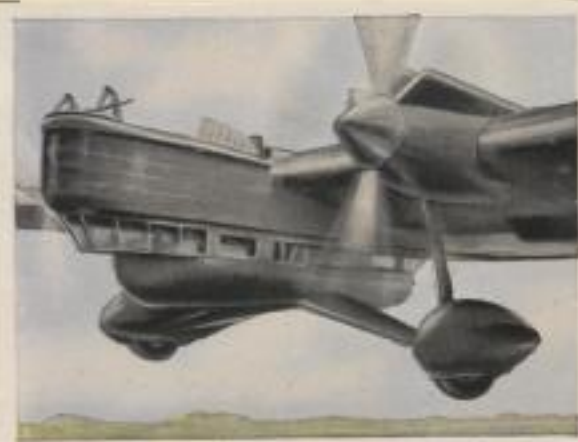
Französisches Mehrzweckflugzeug „S.E.C.M. 140“. Motorleistung 2x700 PS. Höchstgeschwindigkeit 240 km pro Std. Flugweite 800 km. Bombenlast 900 kg.
