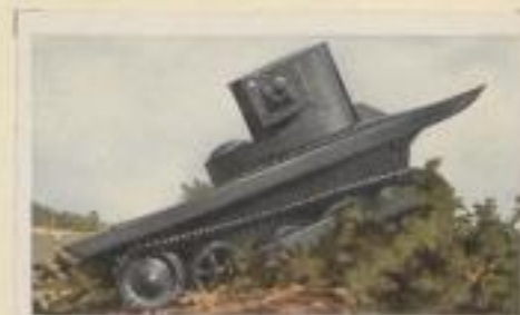
Englischer 3-Mann-Tank, geeignet zur Fortbewegung auf Land und Wasser, Höchstgeschwindigkeit 65 km auf Land, 10 km im Wasser
