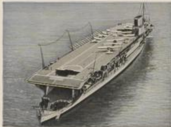
Englisches Flugzeugmutter Schiff „Hercules“. Besatzung 800 Mann. Wasserverdrängung 24450 t. Fassungsvermögen 40 Flugzeuge
