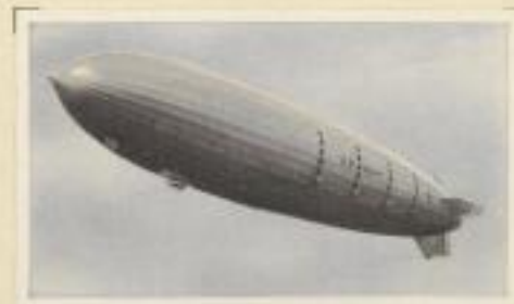
Amerikanisches Marineluftschiff „Macon“. Es dient zur Fernaufklärung und zur Unterstützung der Seestreitkräfte. Zur Verteidigung werden 5 Jagdflugzeuge an Bord mitgeführt
