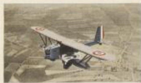
Französisches Mehrzweckflugzeug „Breguet 412“. Motorleistung 2x700 PS. Höchstgeschwindigkeit 345 km pro Std. Flugweite 1000 km. Bombenladung 600 kg.
