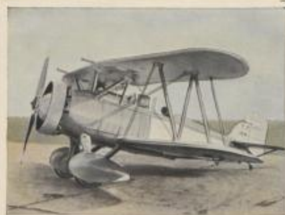
Amerikanischer Aufklärer „Curtiss Hellbiber O 2 C 2“. Motorleistung 650 PS. Höchstgeschwindigkeit 285 km pro Std. Gipfelhöhe 5700 m. Flugweite 600 km
