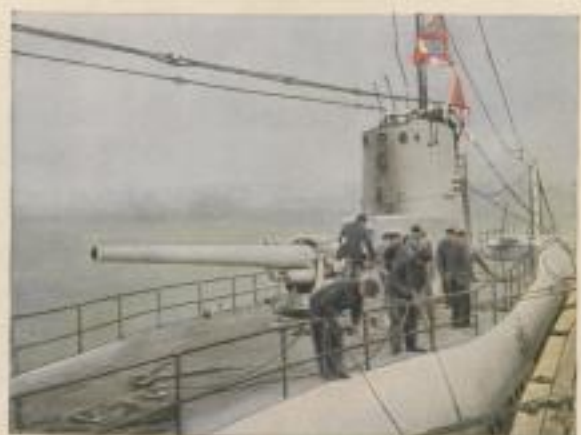
Amerikanisches U-Boot „V 4 Argonaut“ mit Deckgeschütz. Kaliber 15,2 cm. Schußweite 17,3 km. 4 Torpedoausstoßrohre
