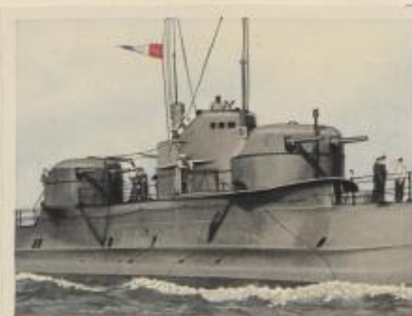
Geschützturm und Kommandobrücke des größten englischen U-Bootes „X 1“ Bestückung 4 × 13,2 cm Kanonen und 4 Torpedoausstoßrohre
