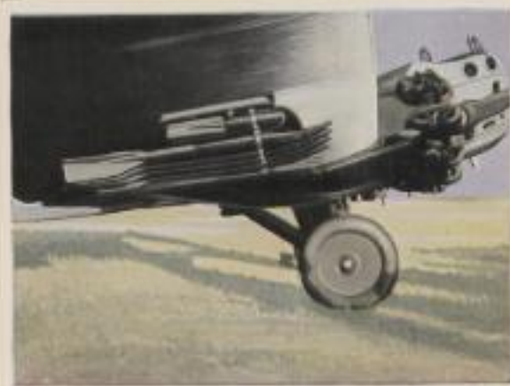
Japanischer Tagbomber. Die Bombenlast in Form von 50 und 12 kg Bomben ist unter dem Tragdeck aufgehängt. Die einzelnen Bomben werden vom Beobachter durch Kabelzüge ausgelöst.
