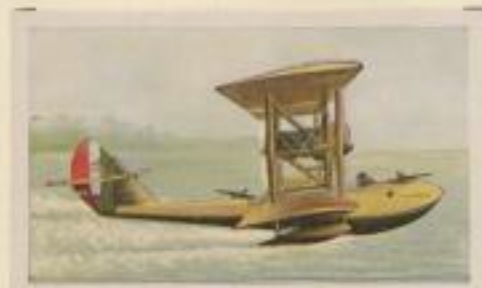
Italienisches Aufklärungsflugboot „Savoia S 62“. Motorleistung 750 P.S. Höchstgeschwindigkeit 225 km pro Std. Gipfelhöhe 4500 m. Flugweite 1000 km
