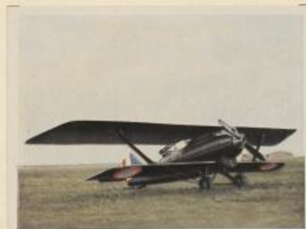
Französischer Aufklärer „Breguet 19“. Motorleistung 450 PS. Höchstgeschwindigkeit 220 km pro Std. Gipfelhöhe 7200 m. Flugweite 600 km
