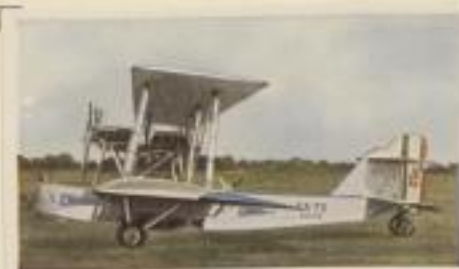
Italienischer Nachtbomber „Caproni 73ter“. Motorleistung 2 x 500 P.S. Höchstgeschwindigkeit 200 km pro Std. Flugweite 1000 km. Bombenlast 900 kg
