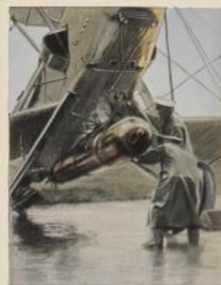
Torpedoanlage des englischen Torpedoträgers „Blackburn Ripon 2“. Der Torpedo hängt in der Vorrichtung unter dem Rumpf, die vom Beobachter durch Kabelzüge ausgelöst wird
