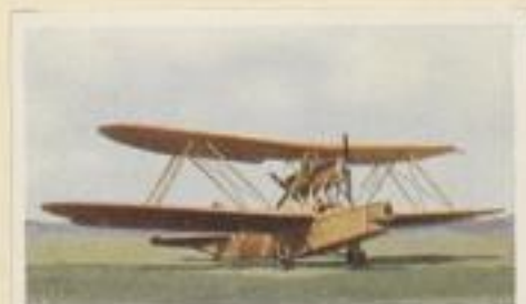
Italienischer Nachtbomber „Caproni 103 Bis“. Motorleistung 2 x 750 P.S. Höchstgeschwindigkeit 200 km pro Std. Flugweite 1000 km. Bombenlast 1000 kg
