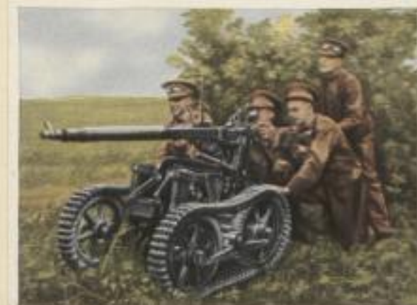
Englisches Tankgeschütz auf Selbstschlepplafette zur Abwehr und Vernichtung von leichten und schweren Kampfwagen
