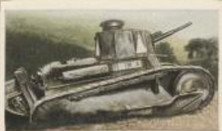
Italienischer Fiat-Tank mit 37 mm Kanone und einer Höchstgeschwindigkeit von 24 km pro Std.
