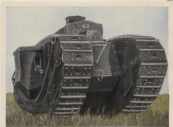
Schwerer amerikanischer Tank im Kampfgebiet. Die Panzerung beträgt 25-30 mm und die Höchstgeschwindigkeit 20 km pro Std.
