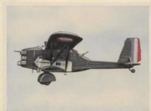
Französisches Mehrzweckflugzeug „Breguet 411“. Motorleistung 2 x 650 P.S. Höchstgeschwindigkeit 330 km pro Std. Flugweite 1000 km. Bombenladung 500 kg
