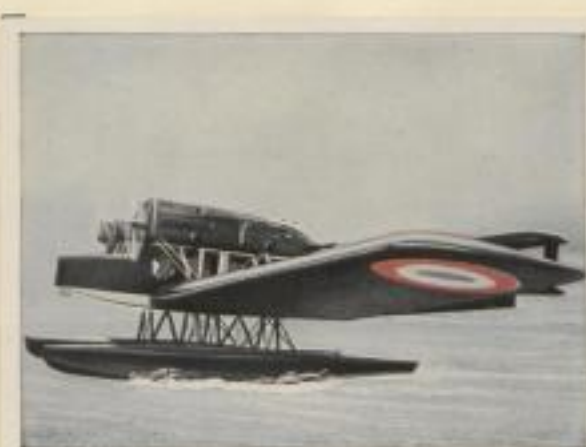
Französisches Verbindungsflugzeug „Blériot B 195 W“. Motorleistung 4 x 250 P.S. Höchstgeschwindigkeit 195 km pro Std. Flugweite 960 km. Nutzlast 500 kg
