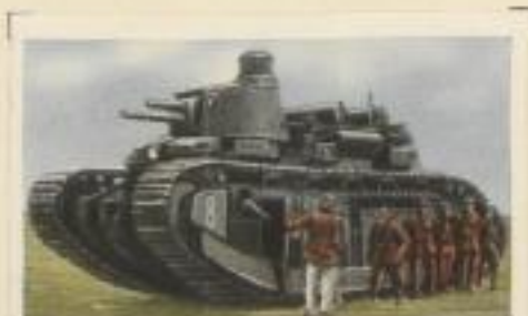
Schwerster französischer Tank „Char 2C“. Besatzung 1 Offizier und 10 Mann. Bewaffnung 1 x 75 mm Kanone, 4 MG. Munitionsvorrat 150 Schuß 75 mm und 10000 MG-Schuß. Motorstärke 600 PS.
