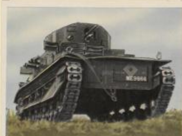
Englischer Medium-Vickers-Tank „Mk. 2“, Besatzung 5 Mann. Bewaffnung 1 x 47 mm Kanone, 4 MG. Munitionsvorrat 90 Schuß 47 mm und 5000 MG-Schuß
