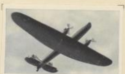
Engl. Langstreckennachtbomber „Fairey Night Bomber“. Motorleistung 2×500 P.S., Höchstgeschwindigkeit 330 km pro Std. Flugweite 3500 km. Bombenlast 1000 kg
