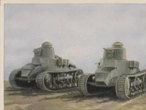
Polnische Tanks im Angriff. Besatzung 3 Mann. Bewaffnung 75 mm Kanone und 2 MG.
