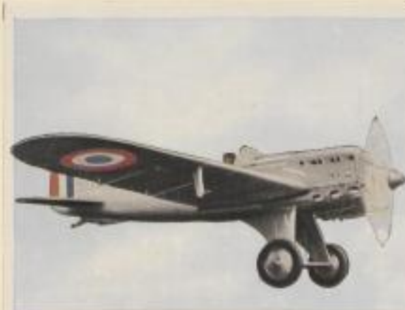
Französischer Jagdeinsitzer „Bernard 20C1“. Motorleistung 500 PS. Höchstgeschwindigkeit 330 km pro Std. Gipfelhöhe 9250 m. Bewaffnung 2 starke MG.
