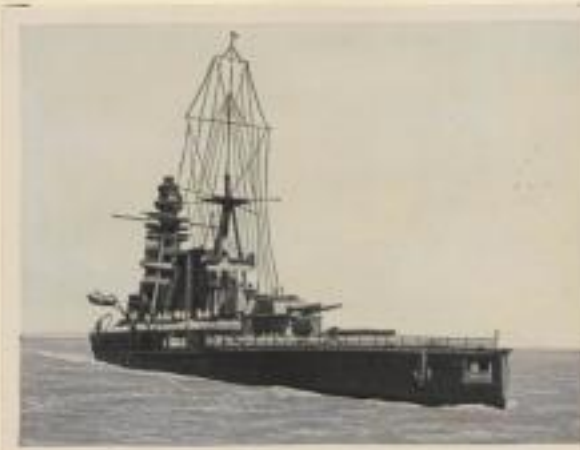
Japanisches Linienschiff „Mutsu“. Besatzung 1340 Mann. Wasser- verdrängung 34500 t. Besetzung 8×40,6 und 20×14 cm Kanonen und 8 Torpedoausstöße
