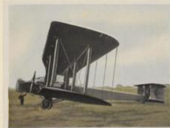
Englischer Nachtbomber „Vickers Virginia“. Motorleistung 2 x 500 P.S. Höchstgeschwindigkeit 180 km pro Std. Flugweite 1500 km bei einer Bombenladung von 1000 kg
