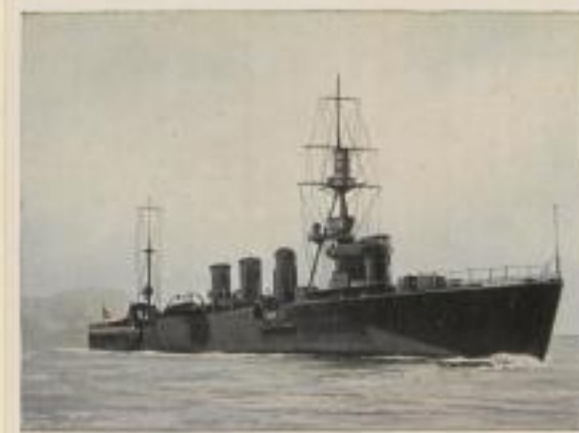
Japanischer Kreuzer „Satsuma“. Besatzung 440 Mann, Wasserverdrängung 5500 t, Bewaffnung 7 × 14 cm Kanonen, 2 × 8 cm Flak und 8 Torpedorohrer, Geschwindigkeit 33 km
