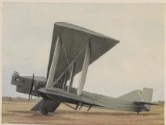
Polnischer Nachtbomber „Pzlan P 165“. Motorleistung 2×420 P.S., Höchstgeschwindigkeit 160 km pro Std. Flugweite 700 km. Bombenlast 750 kg
