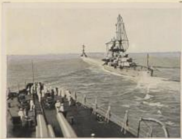
Italienischer Panzerkreuzer „Zara“. Besatzung 830 Mann. Wasser- verdrängung 10000 t. Besetzung 8×30,3 und 16×10 cm Geschütze. Geschwindigkeit 32 km
