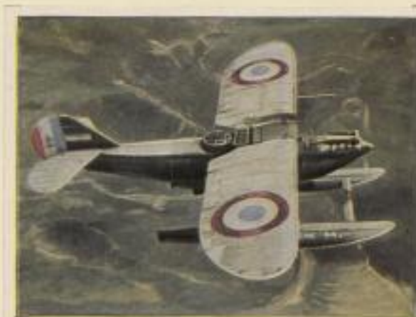
Französischer Torpedoträger „Caterpillar 44“. Motorleistung 650 P.S., Höchstgeschwindigkeit 225 km. Bombenlast 1 Torpedo von 700 kg
