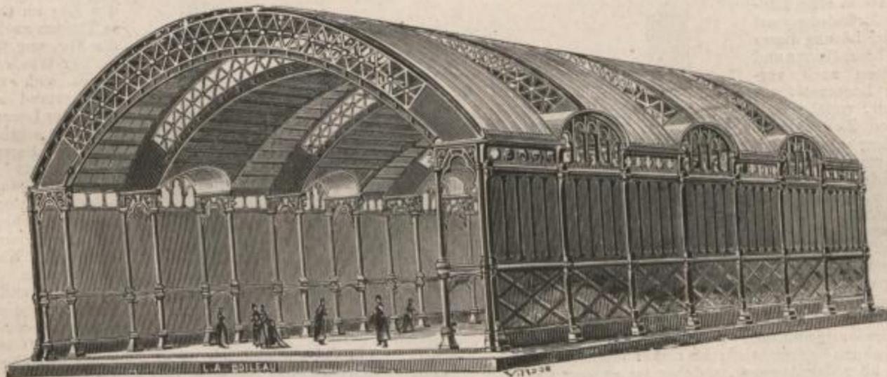
Diese Bauten entbehren aber jedes decorativen Charakters und erfordern ausserdem eine ziemlich enge Säulenstellung, können also nicht für die Ueberdachung grösserer Hallen angewendet werden. Das in unserer Abbildung dargestellte System des Architekten L. A. BOILEAU in PARIS löst in höchst ingenieuser Weise das Problem einer freitragenden Ueberdachung mit Oberlicht, welche alle Mängel der bisher-
