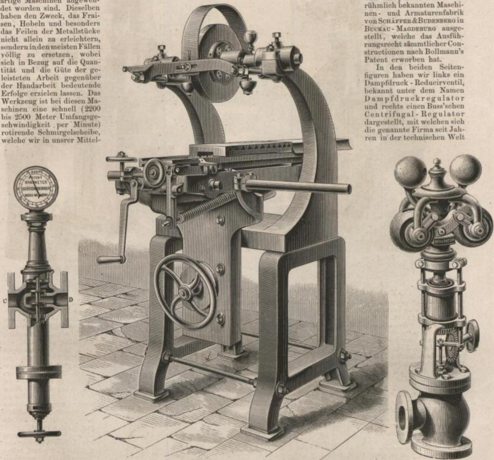
figur oben in den beiden hornförmigen Trägern gelagert sehen. Das Arbeitsstück wird auf dem darunter befindlichen Tisch aufgespannt, der in ähnlicher Weise wie der Support einer Drehbank oder Hobelmaschine nach allen Seiten hin dreh- und verstellbar ist. Mittelst einfacher Mechanismen wird das Arbeitsstück dem Werkzeug entgegengeführt. Zum Einspannen der Arbeitsstücke
