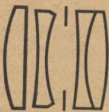
Abb. 17 a Querschnitt eines Apo-Tessars
