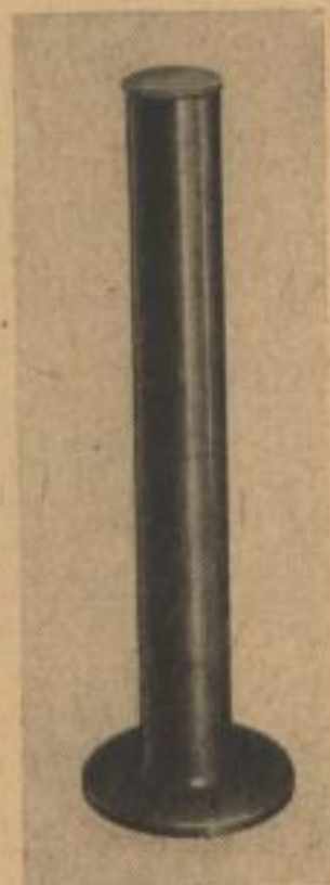
Abb. 50. Einpaßrohr zum Montieren von Filmen für den Farbendruck
