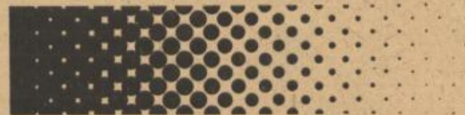
b 4. Rasterpositiv für Offsetdruck vom Vollton bis zum hellsten Ton geätzt
