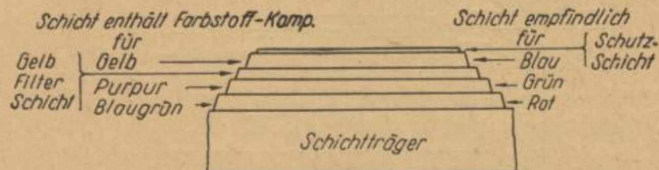
Abb. 92. Schema vom Agfa-Colorpapier nach Dr. Trabert „Das Agfacolor-Papier“
