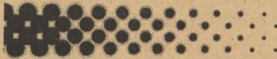
b 1. Rasteraufnahme mit Vorbelichtung, in Durchsicht
