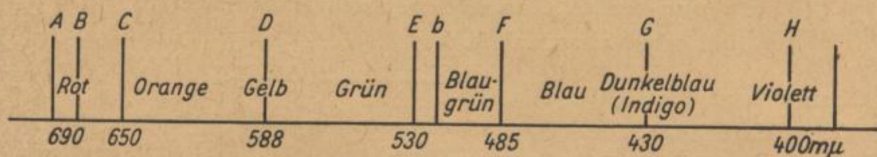
Abb. 14. Schema der Farbstrahlenverteilung im Spektrum
