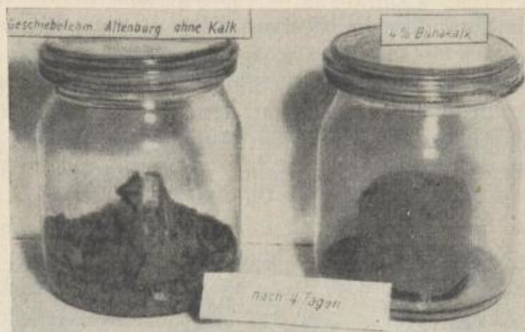
Bild 87 a. Ergebnis einer 28tägigen Wasserlagerung von Geschiebelehm Altenburg + Bunakalk
