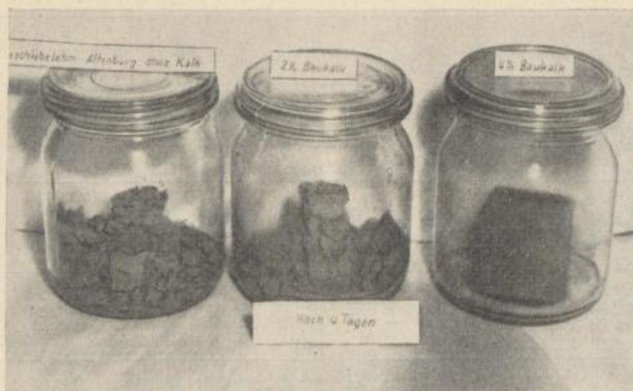
Bild 87 b. Ergebnis einer 28tägigen Wasserlagerung von Geschiebelehm Altenburg + Bornaer Kalk
