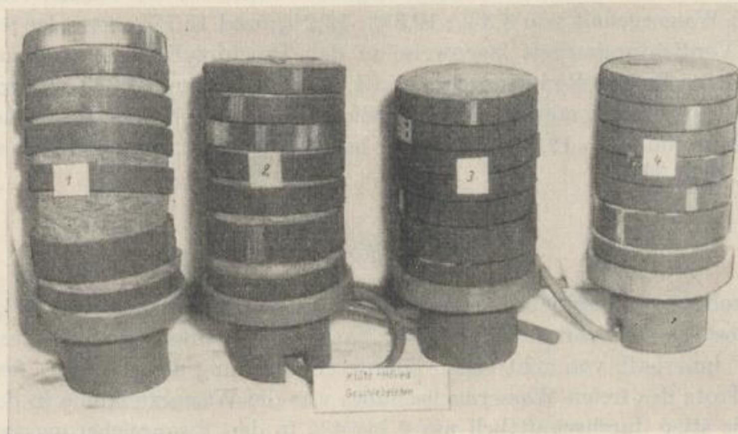
Bild 30 b. Geschiebelehm Klütz — Ergebnis der Frosthebungsversuche
