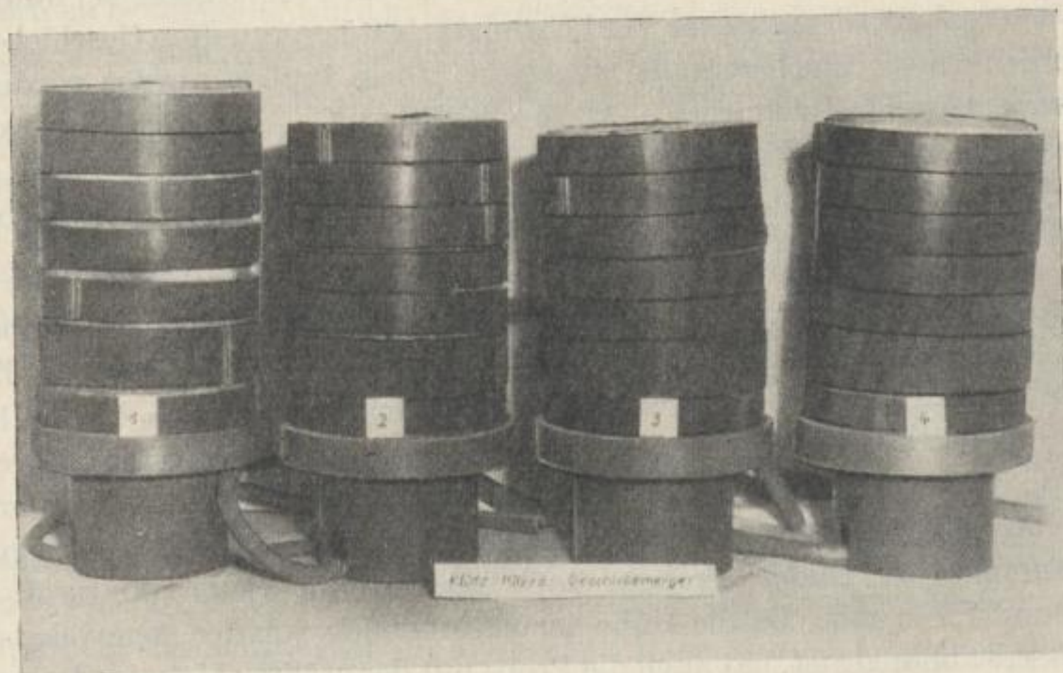
Bild 27 b. Geschiebemergel Klütz — Ergebnis der Frosthebungsversuche
