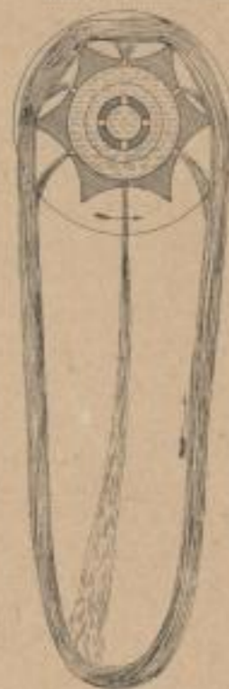
1 a Querschnitt einer Porzellan Wälze
