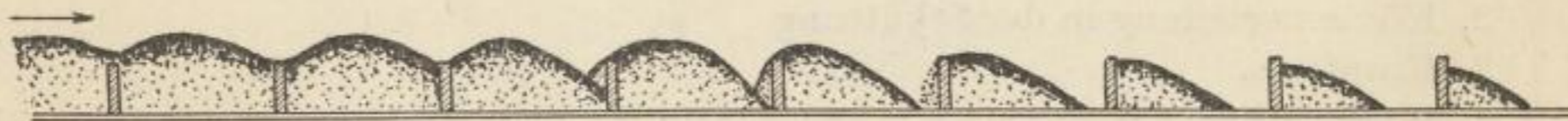
Bild 10. Bewegung der Kohle im Siebkettenförderer
