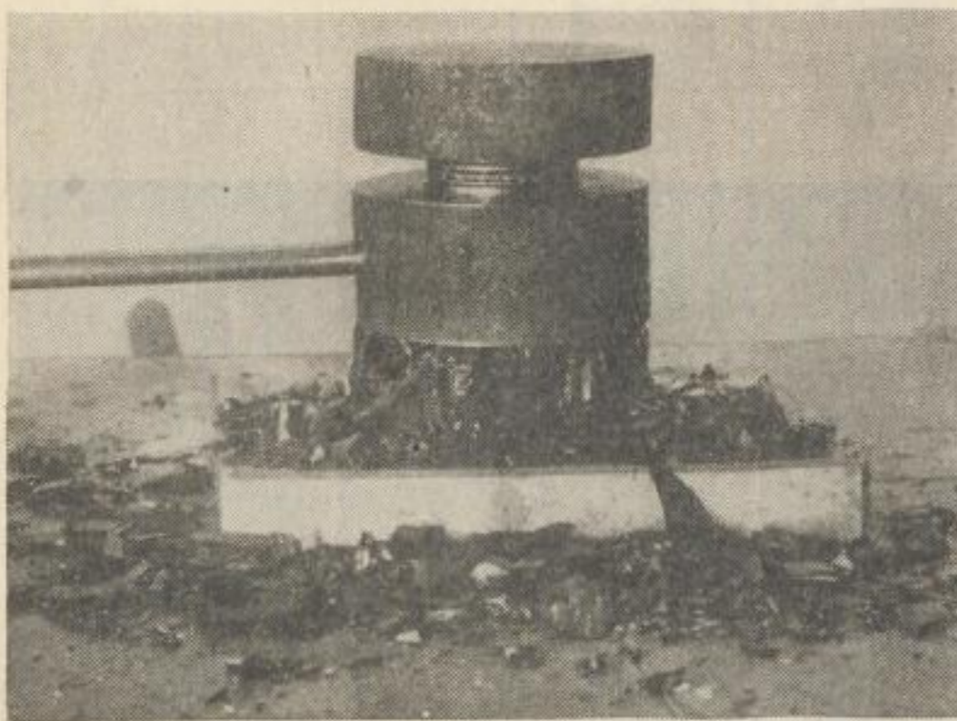
Bild 21. Zerstörung von natürlichem Asphalt durch Zersplittern infolge der Veränderung der Belastungsart und des Deformationscharakters. Die Symbole der Belastung befinden sich im oberen Teil des Bildes
