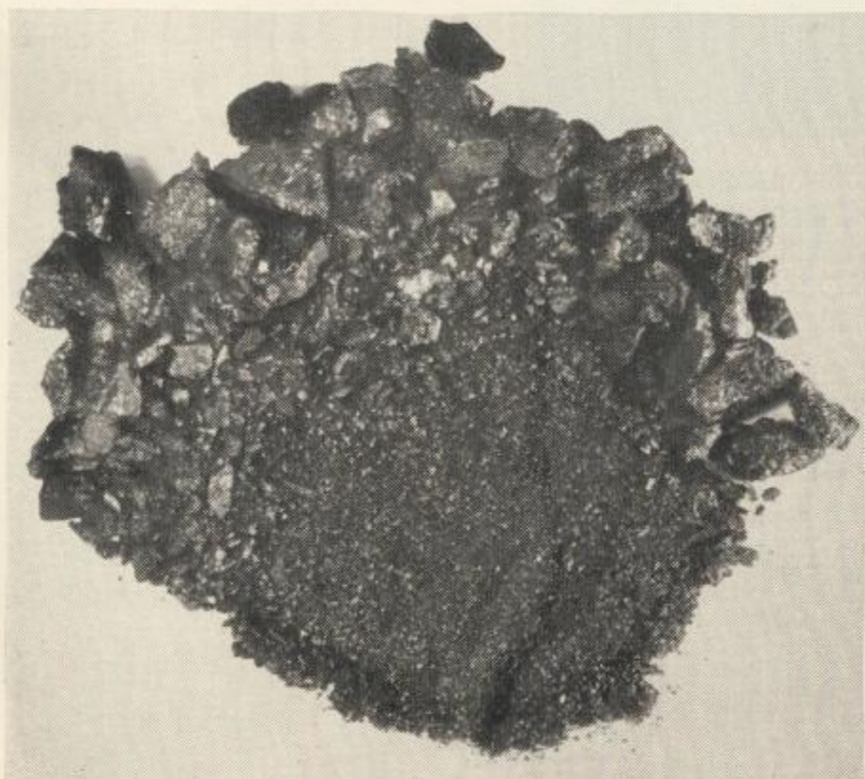
Bild 20. Steinkohle, zerstört durch Zersplittern infolge der Veränderung der Belastungsart und des Deformationscharakters
