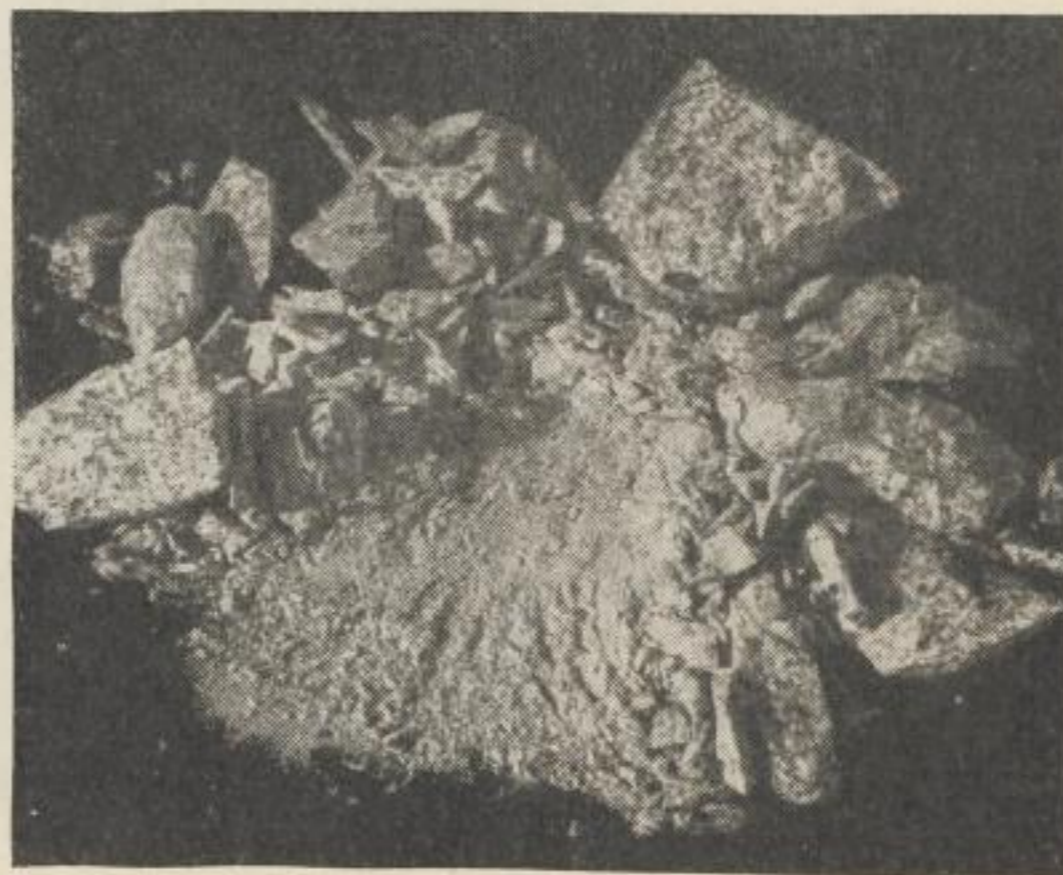
Bild 17. Zerstörung von Granit durch Zersplittern infolge der Veränderung der Belastungsart und des Deformationscharakters. Die Symbole der belastenden Komponenten sind im oberen Teil der Abbildung dargestellt
