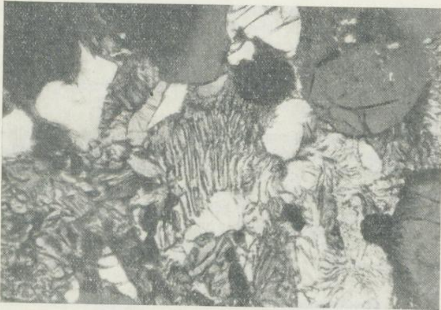
Bild 4. Eklogitamphibolit. Zerfall des Omphacits in Pyroxen-Plagioklas-Symplektit (z. B. Bild-Mitte: wurmförmig durchzogene Körner); daneben Granat (dunkel), Omphacitreste (hell) und z. T. neugebildeter Plagioklas Punkt 536,3 südöstlich Eppendorf (Bl. 116) — V. = ca. 15 : 1
