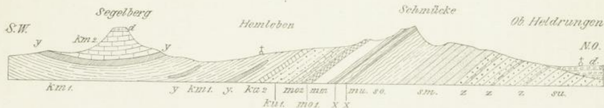
Fig. 31. Profil durch die Trias der Gegend von Oberheldrungen in Thüringen. (Längen = 1:30,000, Höhen = 1:15,000.)
