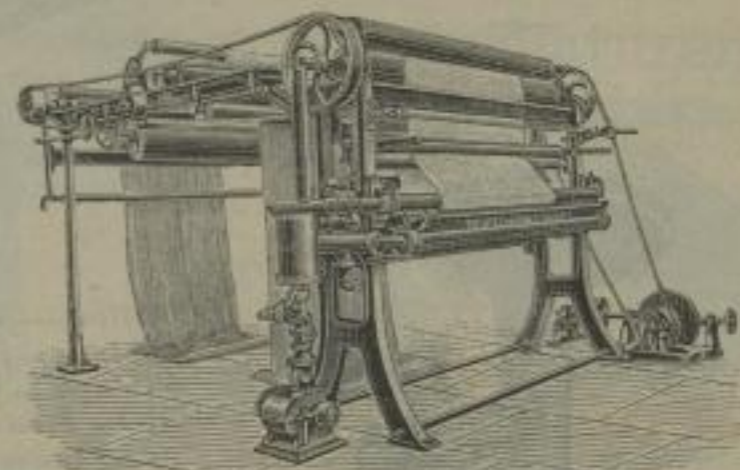
Gassengmaschine mit neuen Schlitzbrennern aus einem Stücke, Injection- und Mischungsapparat, Deutsches Reichspatent.
