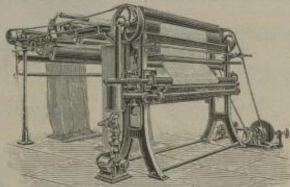
Gassengmaschine mit neuen Schlitzbrennern aus einem Stücke, Injections- und Mischungsapparat.
