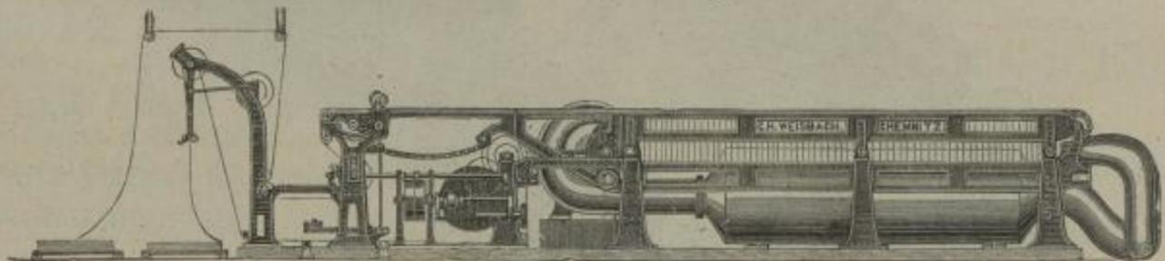
Neueste Rahm- (Spann-) und Trockenmaschine mit Luftheizung, Zwei-Etagen-System, für alle Gewebearten vorzüglichst geeignet, mit Nadel- oder Kluppenkette, auf Wunsch combinirt mit Appretir-Maschine oder Streckapparat. Ueber 200 Stück geliefert.
