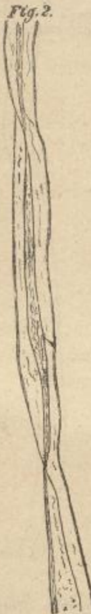
Baumwolle in nicht mercerisirtem Zustande. Vergrößerung ca. 380 fach.
