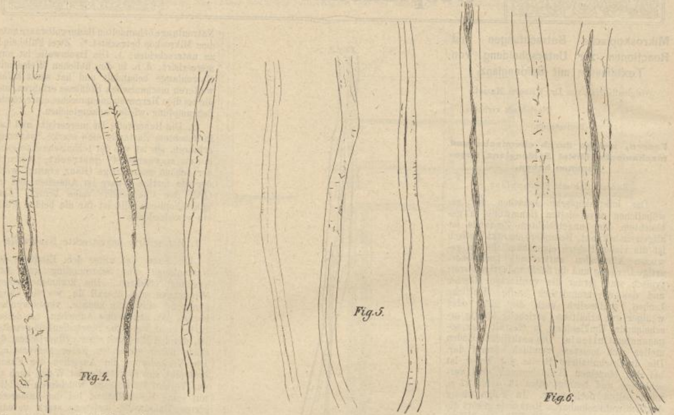
Mercedisirte gestreckte Baumwolle. Vergrößerung ca. 200fach.
