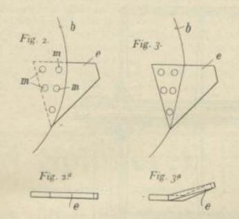
Hingegen stellt e in Fig. 1 eine Schlagnase der neuen Art dar. Die vordere wirksame Kante k dieser Schlagnase ist fast tangential zur Scheibe b gerichtet. An dieser so gerichteten Kante können sich daher in der Regel keine Fäden verfangen. Falls dennoch vielleicht durch eine Rauhigkeit der Oberfläche der Kante k die Neigung zum Festhalten eines Fadens besteht, wird der Faden sofort unter dem Einflusse der Zentrifugalkraft abgeschleudert.
