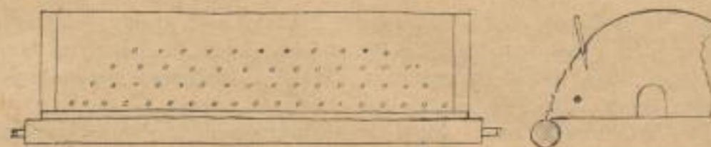
Lochung im Flügeldeckel zur Vermeidung des Baumwollfluges zur Mitte der Maschine.
