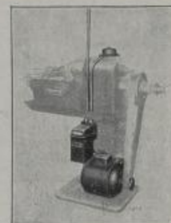
Abb. 9. Vollkommene Sicherung des Motors durch den einfachen Klöckner-M.
