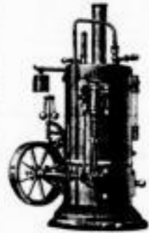
Grosse Modell-Maschine No. 5. Stehender Kessel aus Messing von 9 cm Durchmesser, mit stehendem, festem Cylinder und Excenter-Schiebersteuerung, Sicherheitsventil mit Belastung, Dampfhaube, Prohibitohahn, Regulator, Pfeife, Wasserstand, Lager, Schwungrad und Fass aus Feinguss-eisen. Alle Teile sind geschraubt und zerlegbar, poliert und vernickelt, die Eisensteile fein lackiert. Preis Mk. 33.—
