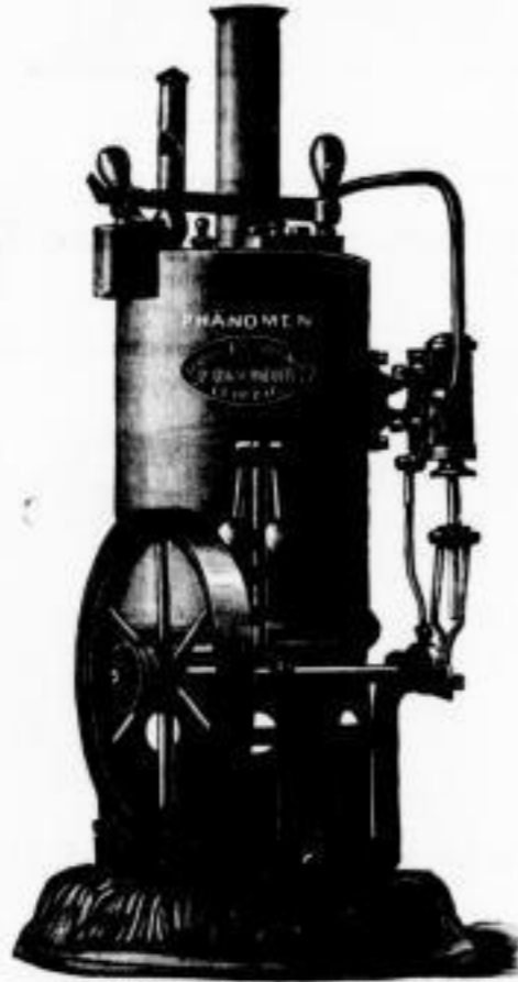
Modell-Dampfmaschine „Phaenomen“. Stehender Kessel aus Messing von 1 cm Durchmesser, mit festem Cylinder und Excenter-Schiebersteuerung, Sicherheits-Belastungsventil, Dampfstrombahn, Regulator, Wasserstand und Pfeife. Lager, Schwungrad und Fass aus Feinguss-eisen. Alle Teile sind geschraubt und zerlegbar, poliert und vernickelt, die Eisensteile fein lackiert. Preis Mk. 12.—
