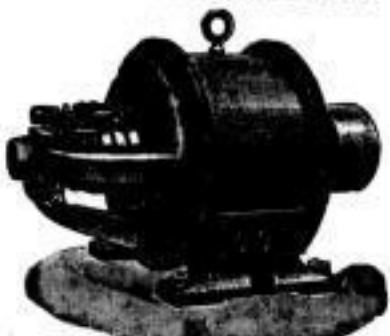
Wechselstrommotor mit Vorrichtg. u. Anschlüssen d. Schließringe u. Abköhlen der Bürsten.
