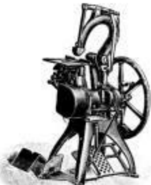
Broschüren-Drahtheftmaschine „Universal“ Nr. 7½.
