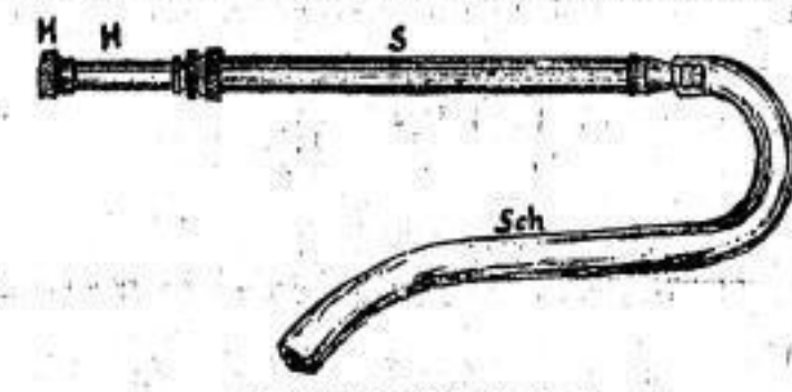
„Pflanz-Fritz“-Handbespritzung M = Mundstück, H = Handgriff der Kolbenröhre, S = Spritzenkörper, Sch = Schlauch
