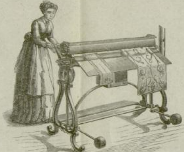
N. 3. Dies ist das zum häuslichen Gebrauch am meisten angewandte Modell. Man bewirkt die Heizung durch Ofen oder Gas.
