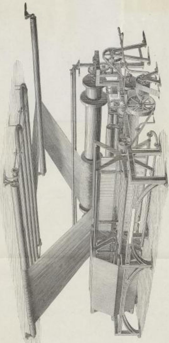
Ketten-, Leim- & Trockenmaschine,
