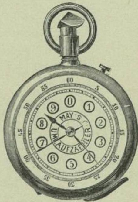
laufzeiger durch Drehen an der Körnerspitze auf 0 zurück. Alsdann hebt man den ebenfalls am Rande des Gehäuses angebrachten Hebel mit sanftem Drucke so lange, bis der Sekundenzeiger auf 0 zurückgekehrt ist; hierdurch wird gleichzeitig das Uhrwerk wieder aufgezogen.
