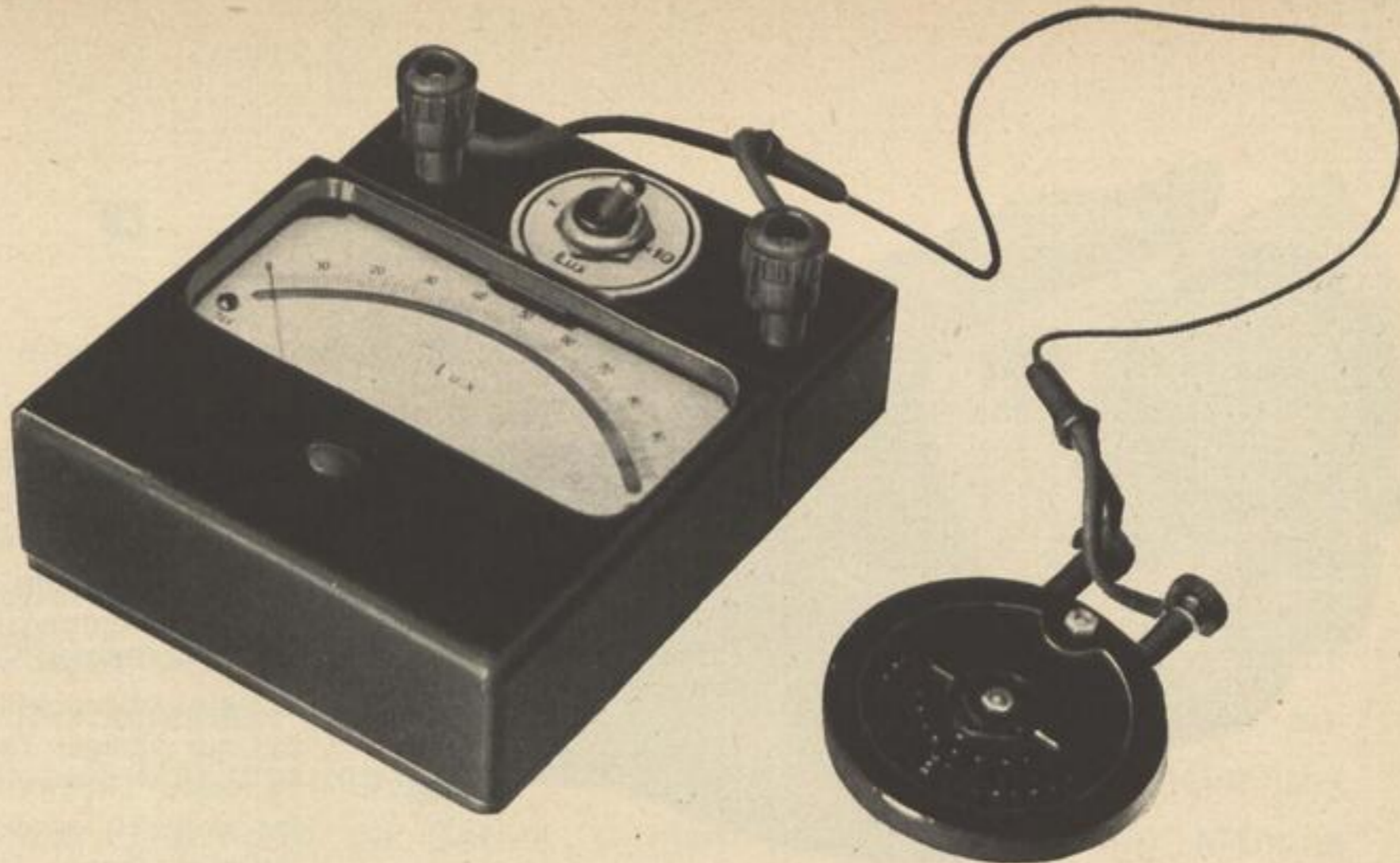
Abb. 6 (oben): Beleuchtungsstärkemesser oder Luxmeter des Lichtingenieurs. Es ist für Filmaufnahmen recht wenig geeignet. Seine Nachteile sind auf Seite 99 geschildert. Es registriert sämtliches aus dem vor der lichtempfindlichen Fläche gelegenen Halbraum stammendes Licht.
