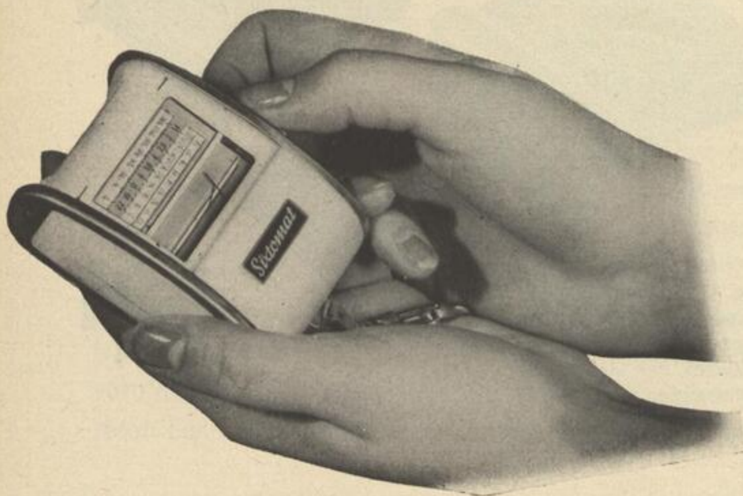
Abb. 11 Instrument, bei dem ein verbindlicher Zahlenwert nur dann abgelesen werden kann, wenn der Zeiger mit einem besonders zu bewegendem Hilfsmittel verfolgt und zur Deckung gebracht wird. Das Gerät bedarf zur Bedienung stets beider Hände. Behende und übersichtliche Relativmessungen sind nicht möglich.
