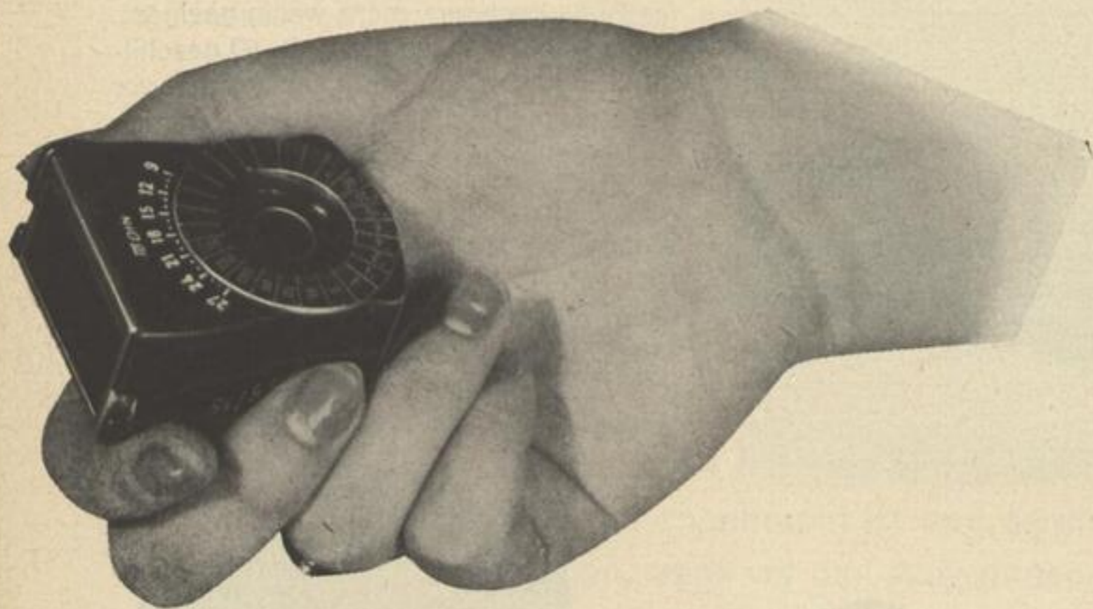
Abb. 10 Sehr einfacher Amateurbelichtungsmesser. An Stelle eines Zeigers bewegt sich eine Scheibe, auf der die Blendenzahlen enthalten sind. Da sich viele Zahlenwerte einander gegenüberstehen, kann der gesuchte Wert auf keinen Fall mit einem Blick herausgefunden werden.
