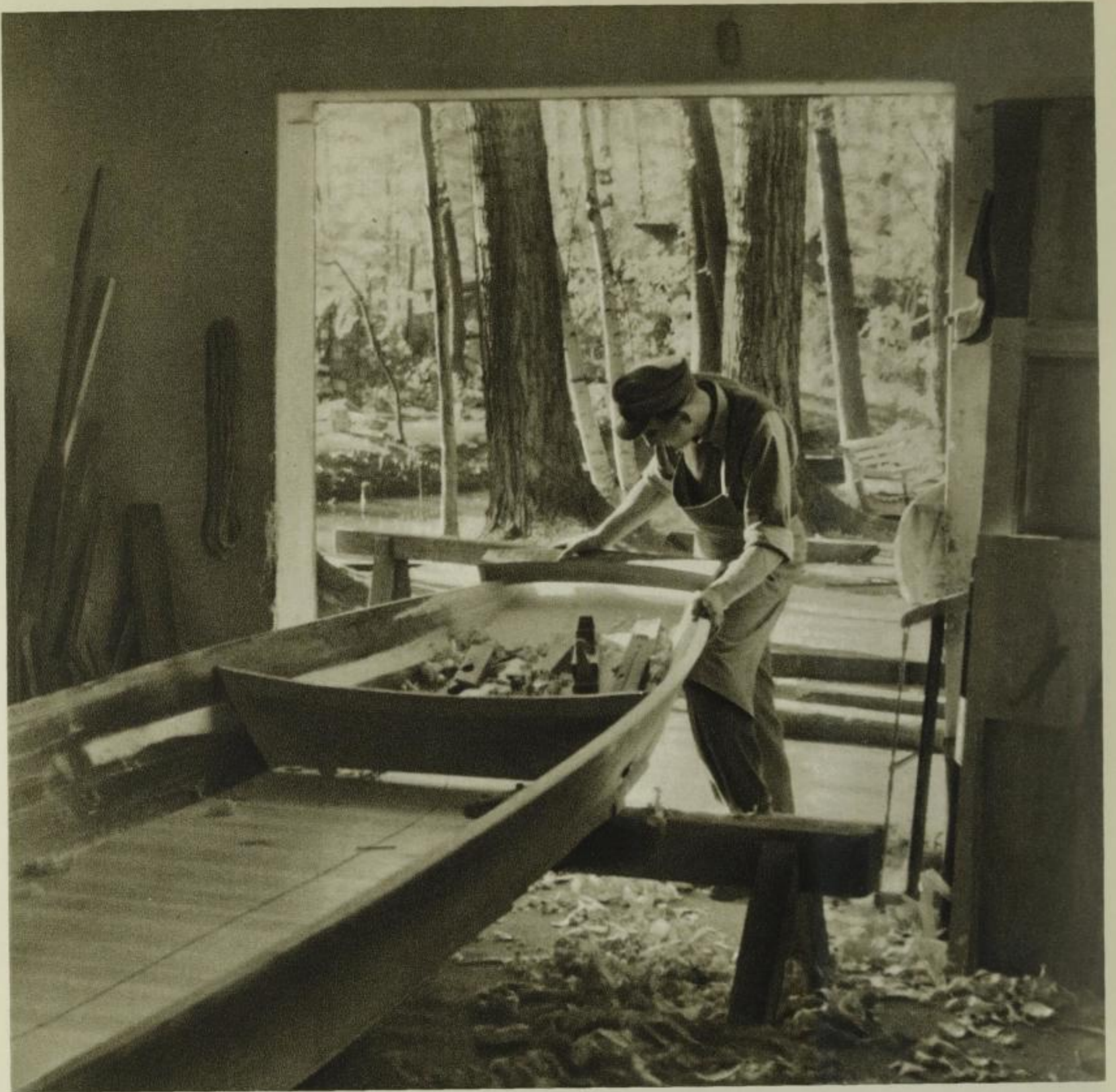
Die handwerkliche Kunst des Kahnbaues besteht darin, das richtige Verhältnis der Spitzen- und Steuerhöhe zur Seitenhöhe des Kahnnes herzustellen
