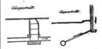
Jede Straffe hat mindestens einen Kanal, und im Zusammenwirken aller dieser Einzelkanäle entsteht für die gaane Stadt ein "Kanalnetz", das alles Abwasser aus der Stadt berausbringt zu einer Abwasserreinigungsanlage. Das Abwasser kann nicht einfach in den nächsten Fluß- oder Bachlauf eingeleitet werden, denn dann würden die weiter abwärts an dem Fluß liegenden Ortschaften in Gefahr gebracht werden, sondern es muß vor seiner Einleitung gereinigt werden.
