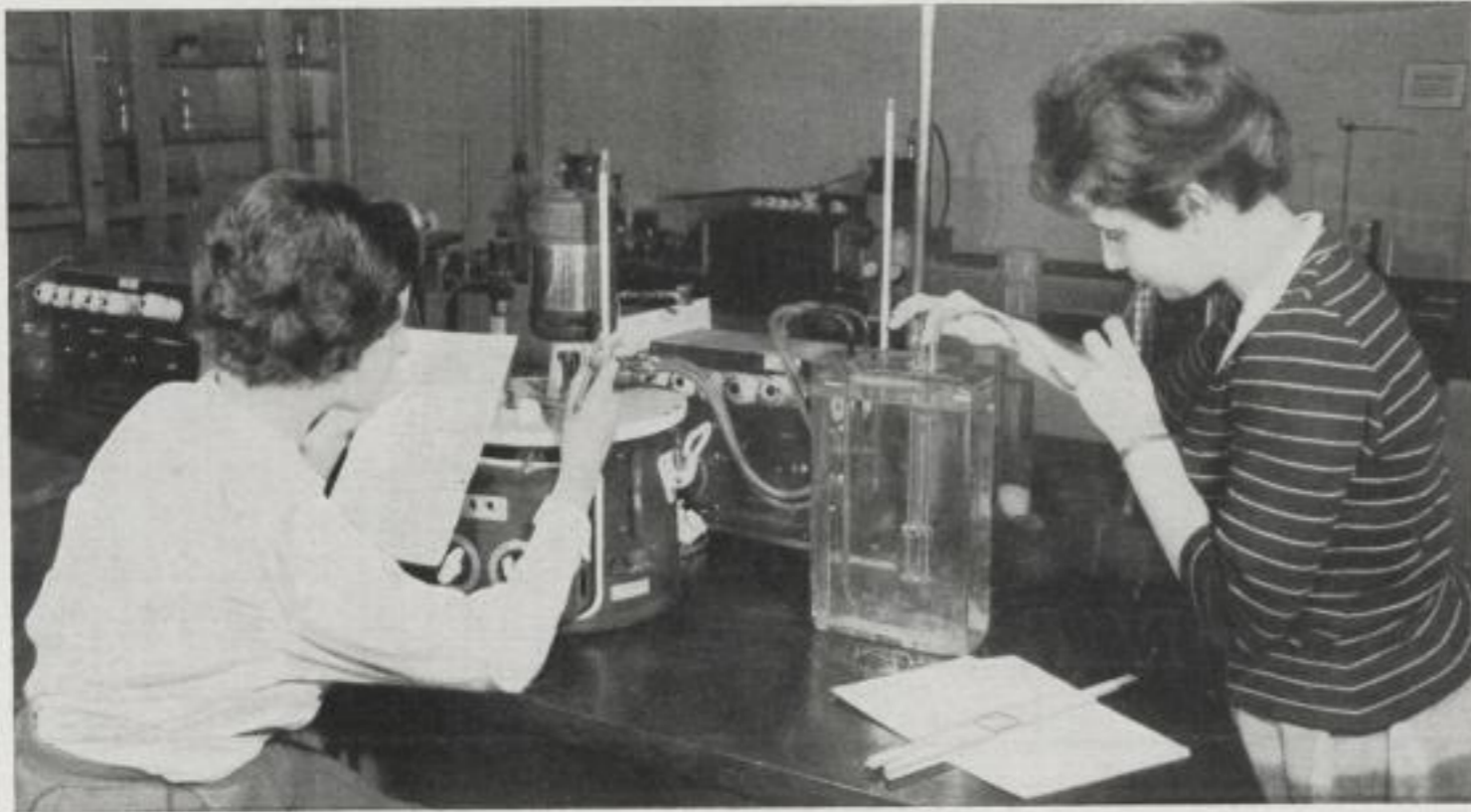
Die Studentinnen Barbara Häusel und Gisa Hofmann bei Messungen der inneren Reibung von Flüssigkeiten im Physikpraktikum
