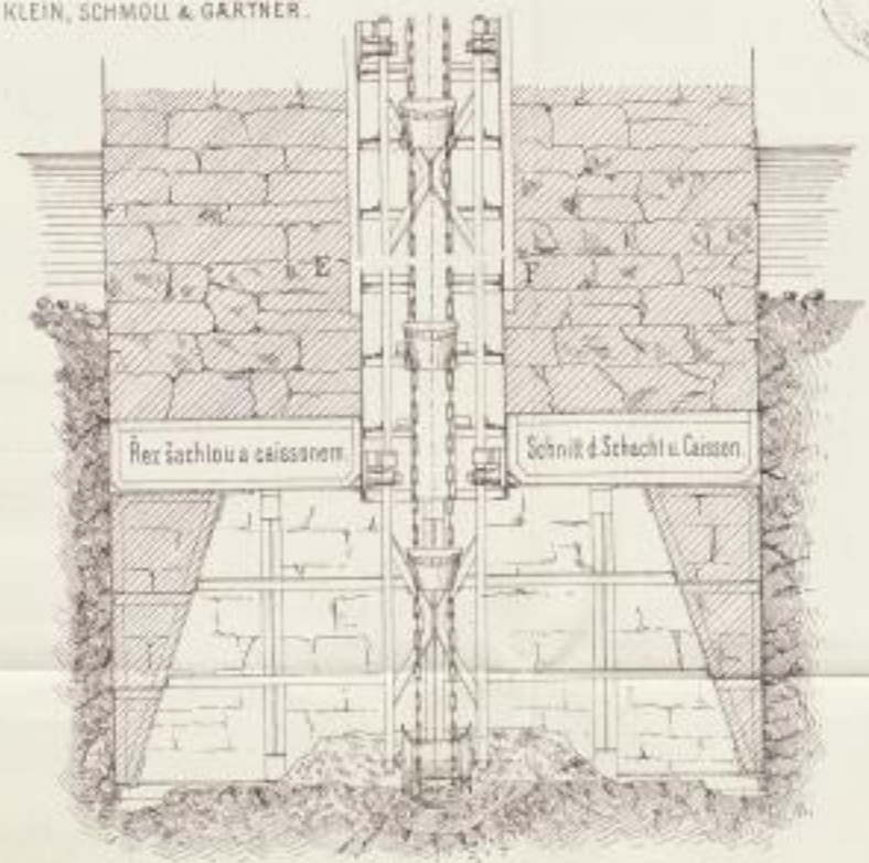
VZDUŠNÍ KOMORA k pneumatickému kladení základů LUFTSCHLEUSSE zum pneumatischen Fundiren System KLEIN, SCHMOLL & GARTNER.
