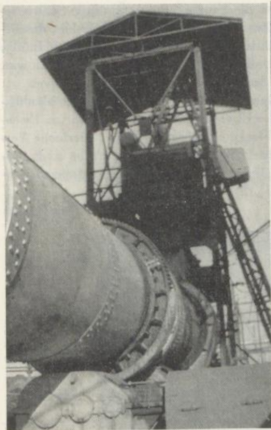
Bild 9. Mit Masut beheizter Drehofen
