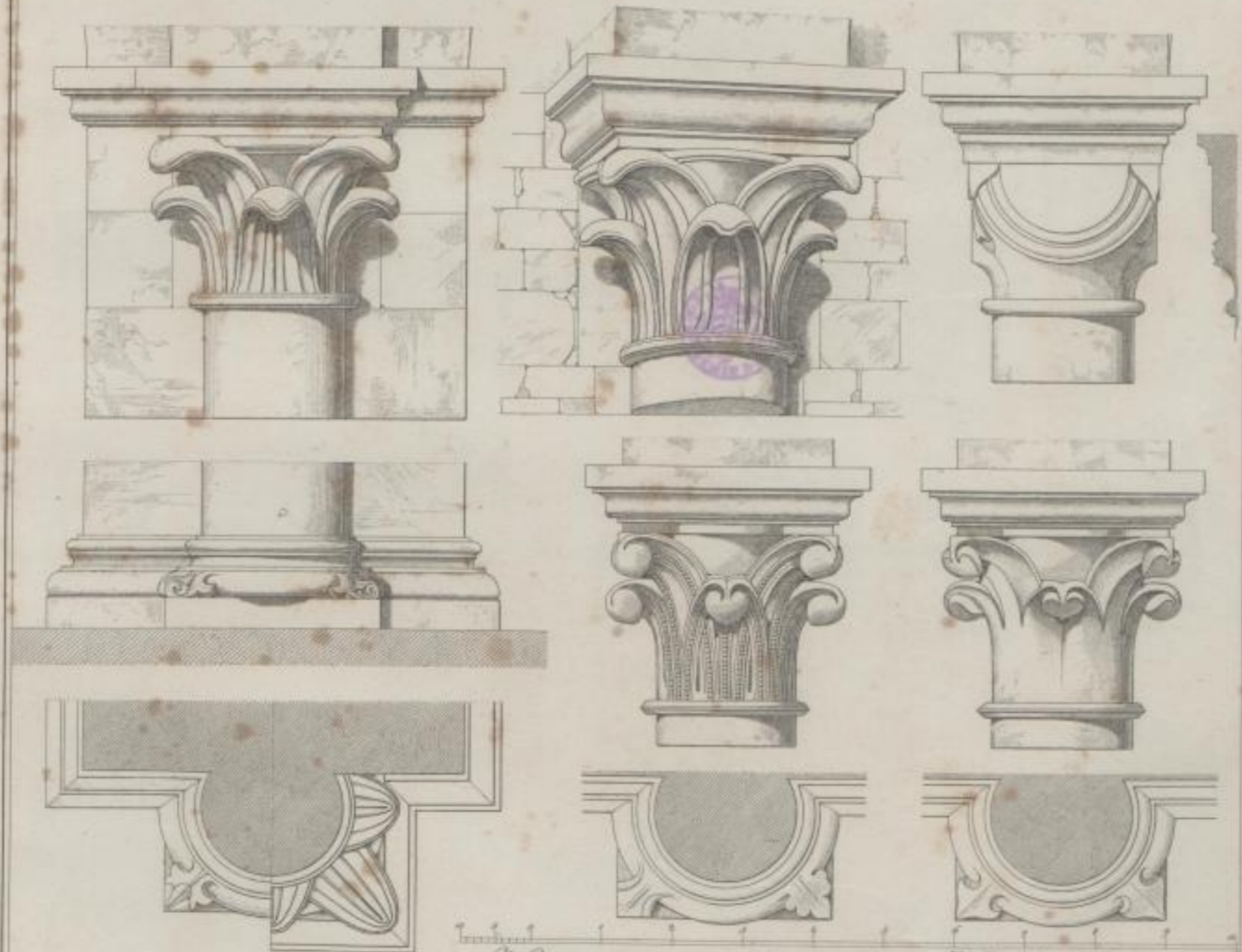
Details der Halbsäulen in den Seitenschiffen
