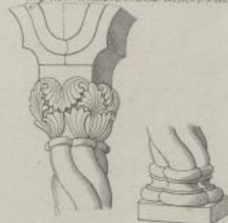
Kapitel und Säulenfuß des kleinen Fensters rechts
