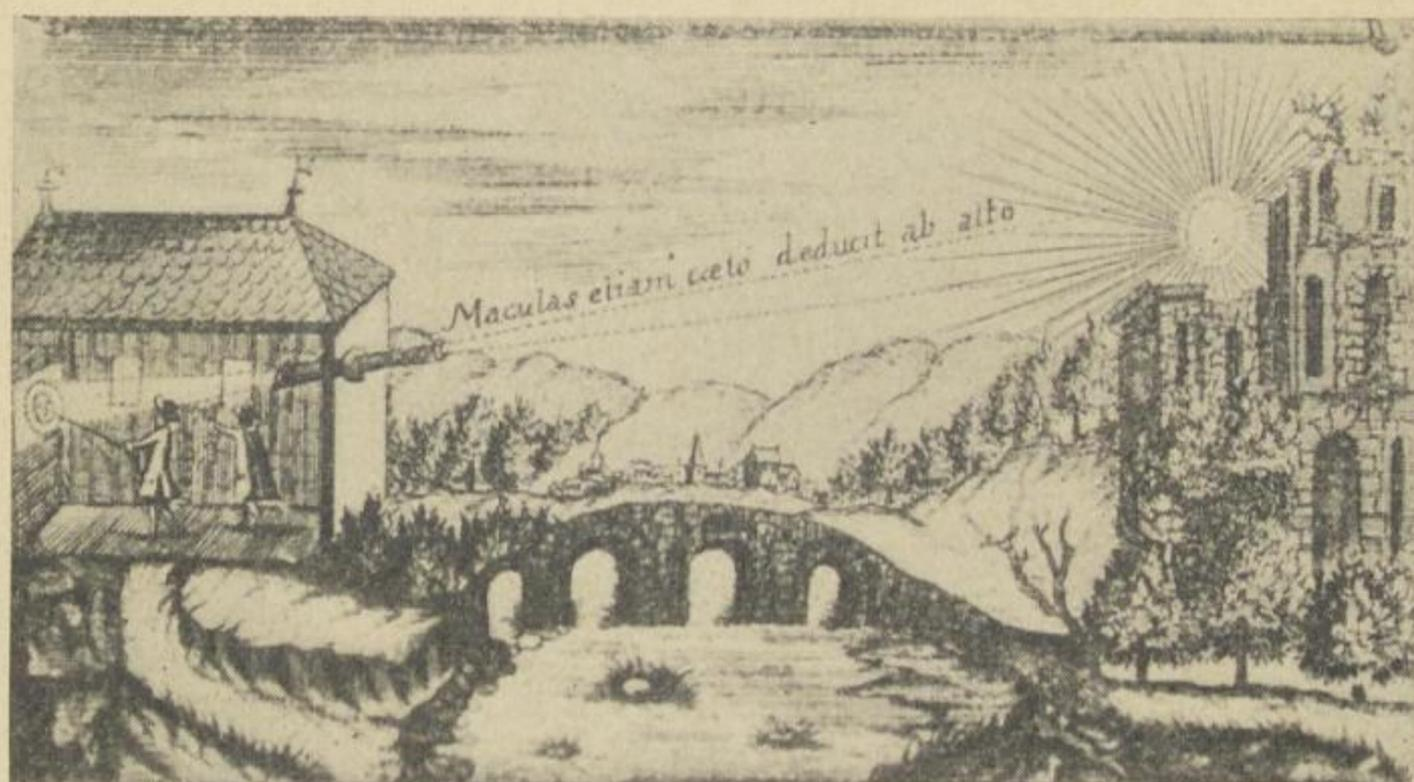
Abb. 3. Sonnenflecken-Projektionsapparat. Um 1685. Das Spruchband lautet: *Maculas etiam caelo deducit ab alto*. Übersetzt: Selbst die Flecken zieht sie (die Machina) von dem Himmel herunter
