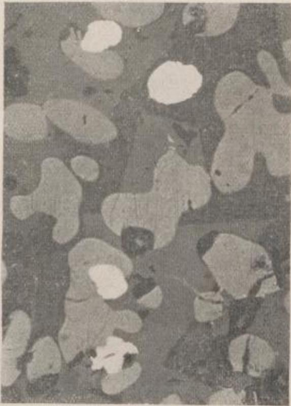
Bild 26. Reduktion des Eisens aus dem Oxyd.  $V = 500$
