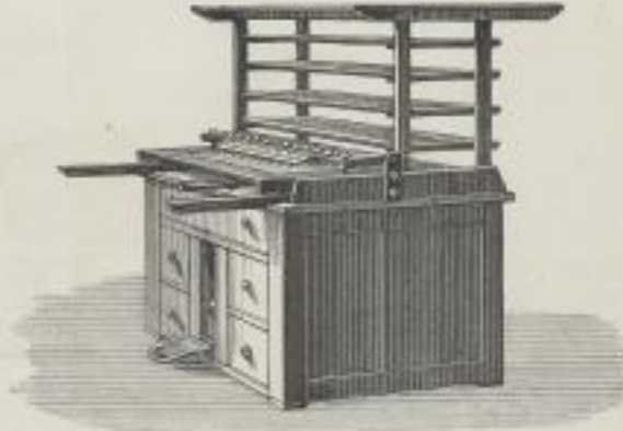
Tisch-Liniir-Maschine. No. 1. 575 mm. Tischbreite . . . . . 20 Thlr. No. 2. 700 mm. . . . . 25 No. 3. 825 mm. . . . . 30 1. Federmechanik. Handl. . . . . 2 1. Zick. gebildeten Masch. pr. 200 mm. 10 Sgr. Faden aller Art werden zu dem (Hilfs) Faden nach dem entsprechenden Maass geliefert.
