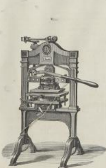
Gold- und Blinddruck-Prägepresse. 625 mm. Durchgangsmass und Schrifftstellung. Heizung durch Gas oder Kohlen 300 Thlr.
