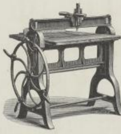
Papier-Schneidemaschine mit 2 Messern 80 Thlr.
