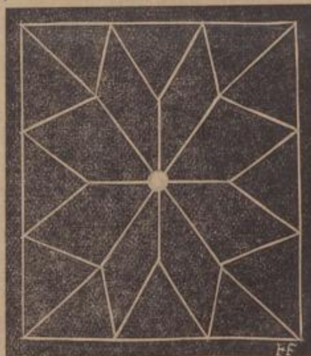
Achteckstern-Wölbung Baugner Ratskeller.
