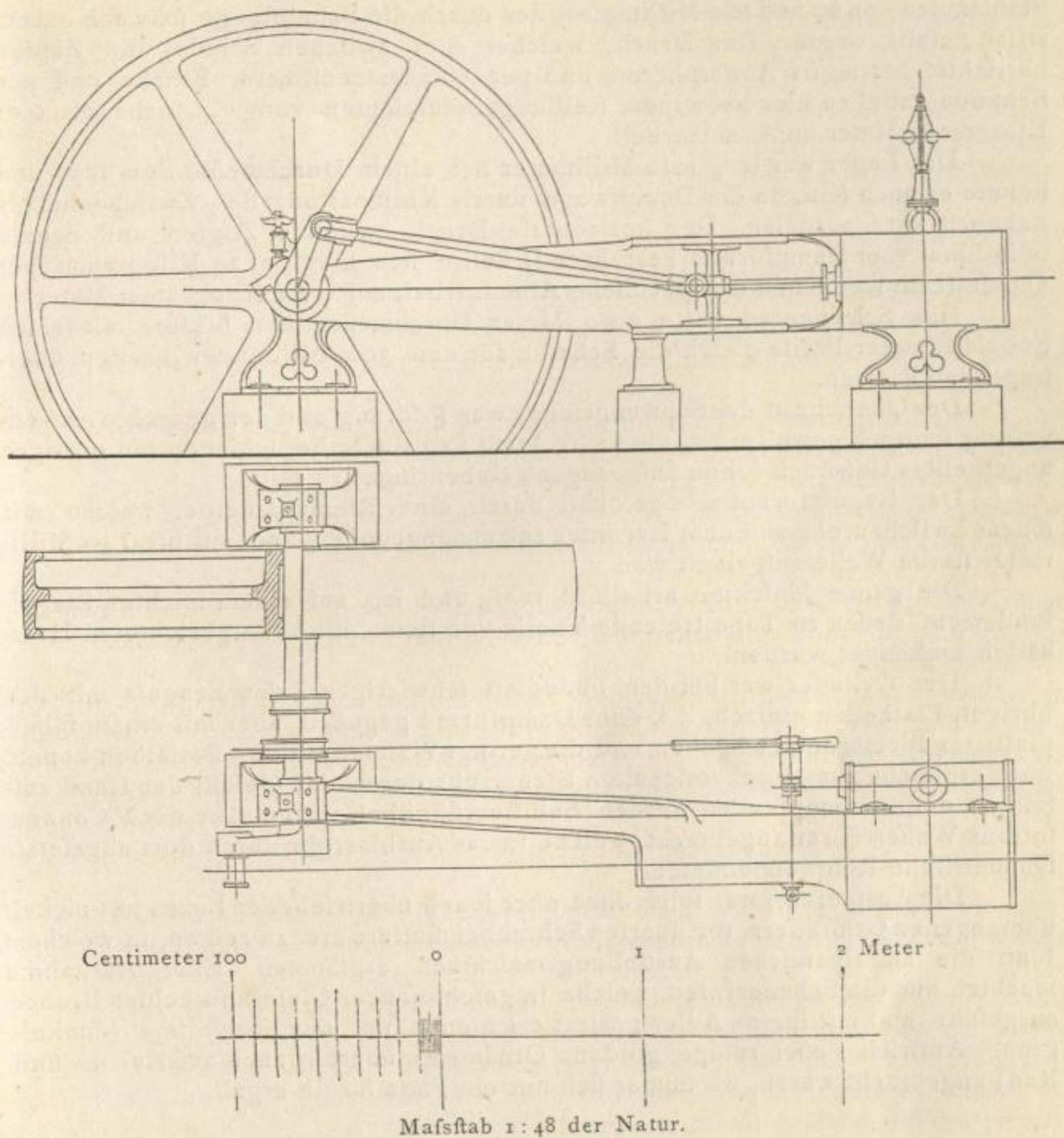
stange aufnahm. Dieser Zapfen, 65 Millimeter lang, 45 Millimeter dick, arbeitet mit 122 Kilogramm per Quadratcentimeter Schalendruck, nachdem sich der gesammte Dampfdruck auf den Kolben (3650 Kilogramm) auf seiner Fläche von nicht ganz 30 Quadratcentimeter concentrirt.
