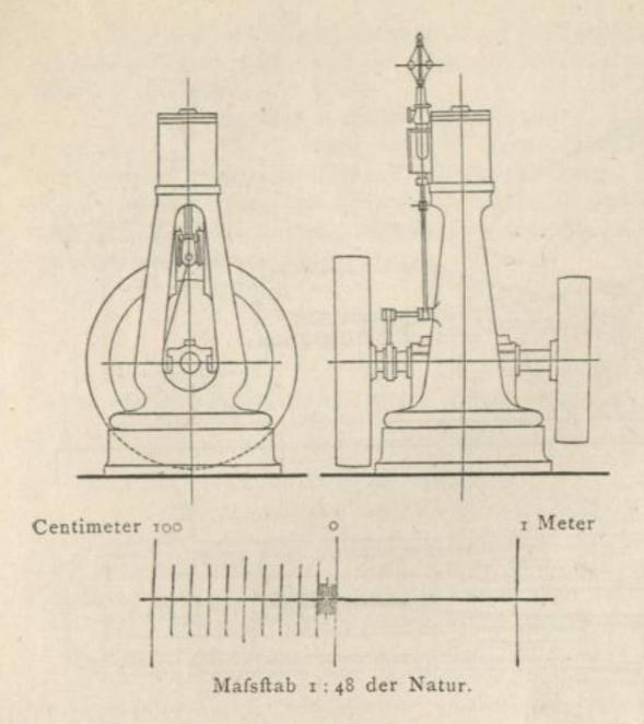
gleichfalls rund. Ein Pickering'scher Regulator stand noch oben am Rohr des Schieberkastens und wirkte auf das Dampsventil direct nach bekann ter Art.
