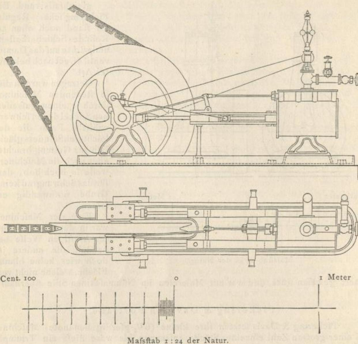
fetzt enthielt. Die mittlere Breite eines solchen Lederkeiles mafs 50 Millimeter und jeden befestigten zwei durch sämmtliche sieben Schichten (35 Millimeter) reichende Niete.
