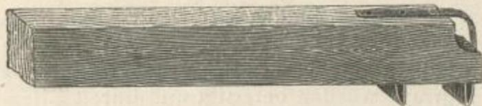
leichter wurden. Die Ruder wurden etwas kürzer gemacht, und am Schafte derselben an der Beschlagsplatte ein Ring angebracht, an welchem ein beweglicher Ruderpflöck mit Bolzen und Mutter an-
