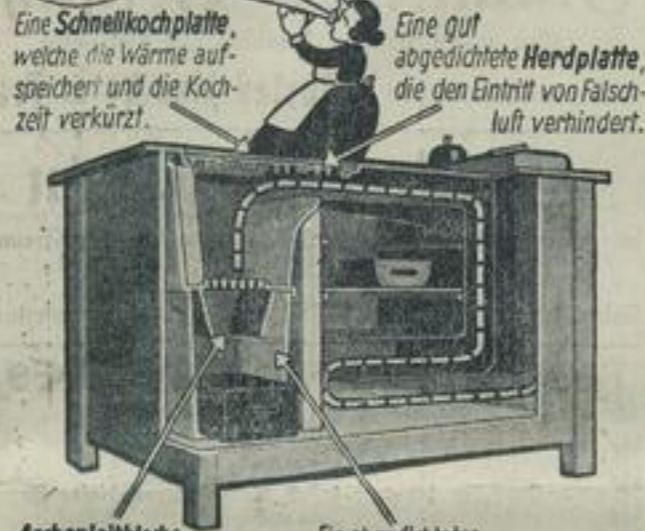
Eine Schnellkochplatte, welche die Wärme aufspeichert und die Kochzeit verkürzt.
