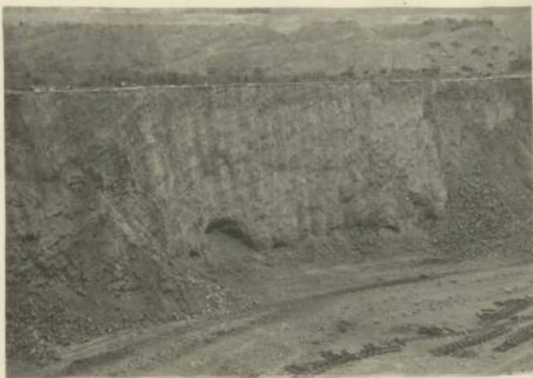
Abb.122b: Bruchwand vor der Sprengung mit Großbohrlöchern u. ms-Zündung.
