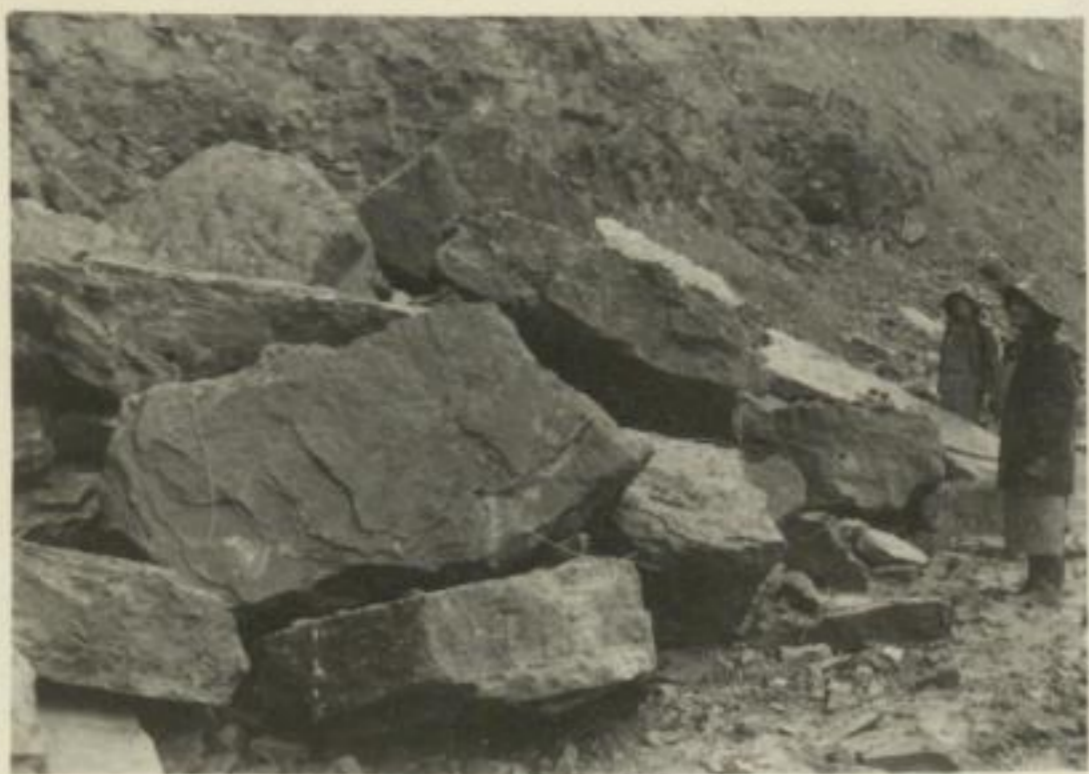
Abb.122a: Nachzerkleinerungsschüsse beim bisherigen Wandsturzverfahren
