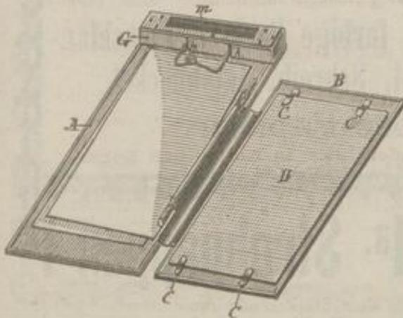
angebracht, und ferner die Klemmfeder h h, welche zum Festhalten eines darunter geschobenen Briefbogens dient. Auf der rechten Hälfte B befindet sich eine Lage Löschpapier D, mittels Klammern C C befestigt. Ein Halter oder Bleistift in einer Hülse vervollständigt das Schreibrequisit.
